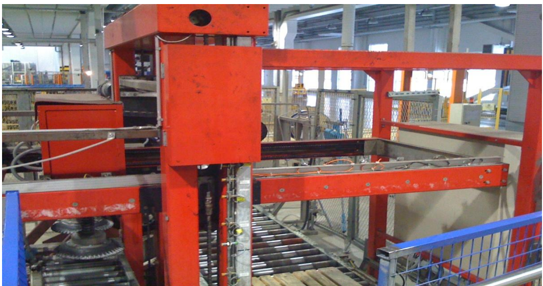
Kuva 4 Kuvassa on lavaajarobotti, joka lavaa täydet panimotynnyrit lavalle.
