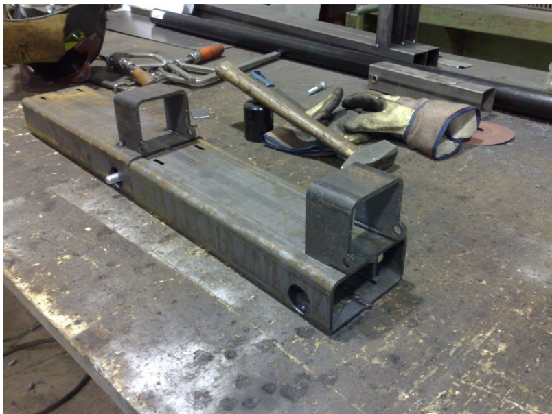
KUVA 19 Ketjupalan proto-osia, osittain kasattuna.
