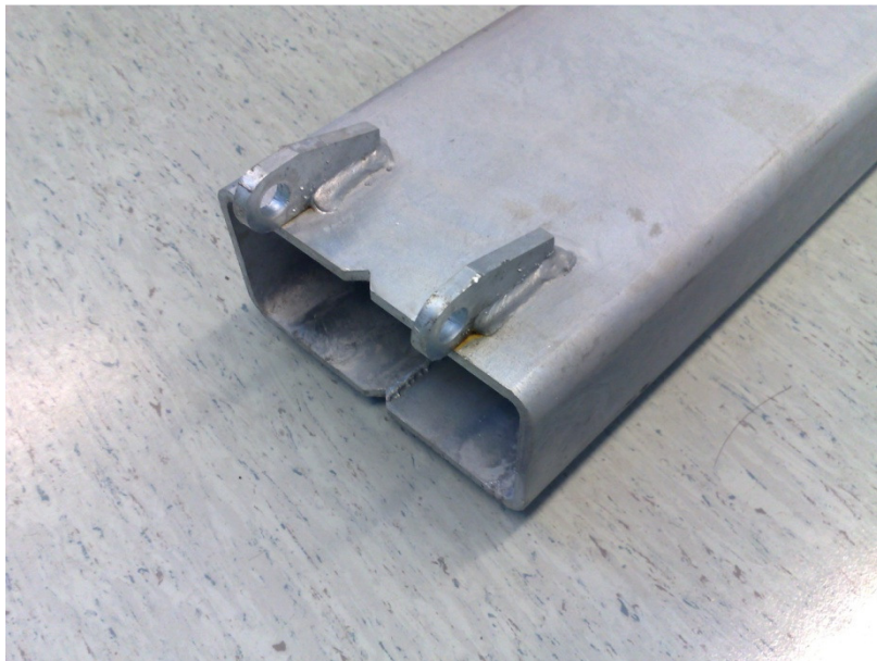
KUVA 22 Kastosinkitty ketjupala, johon on jäänyt sinkkikertymiä
