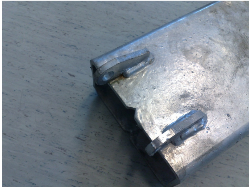
KUVA 22 Kastosinkitty ketjupala, johon on jäänyt sinkkikertymiä
