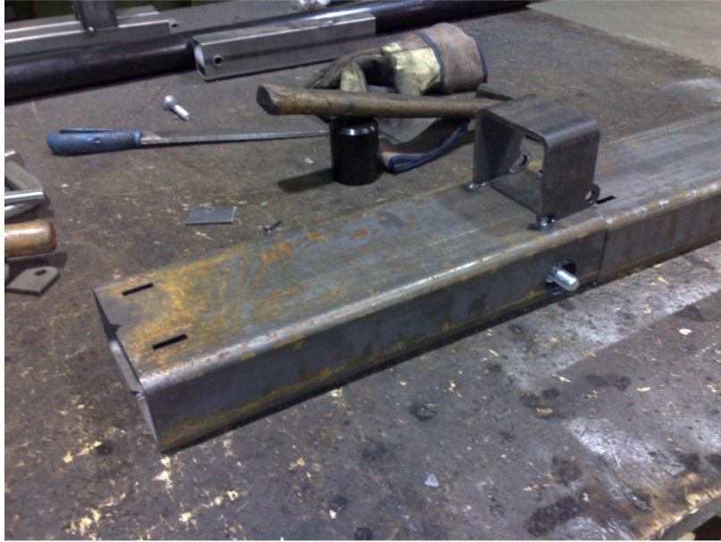
KUVA 20 Ketjupalan proto-osia, osittain kasattuna.
