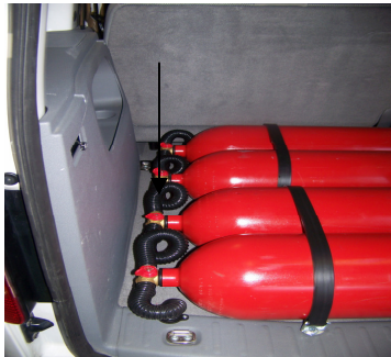
Kuva 21. Yhdysputki pullosta toiseen liitettynä ulkoilmayhteyteen
