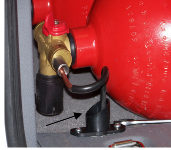
Kuva 24. Ulkoilmayhteys/ tankkausliittimen yhteysputki
