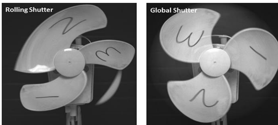
Kuva 7. Rolling shutter ja global shutter -periaatteiden vertailua pyörivää tuuletinta kuvattaessa (Oxford Instruments www-sivut 2019).
