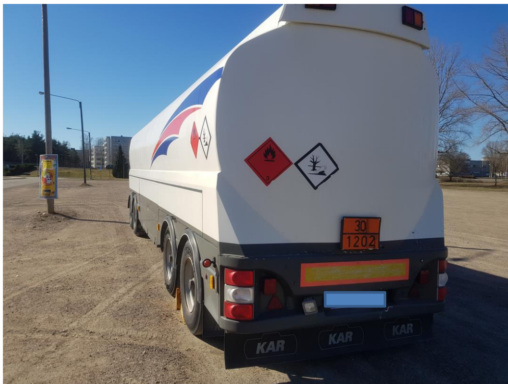
Kuva 34. Kuluneet mutta silti kohtuullisessa kunnossa olevat suurlipukkeet.
