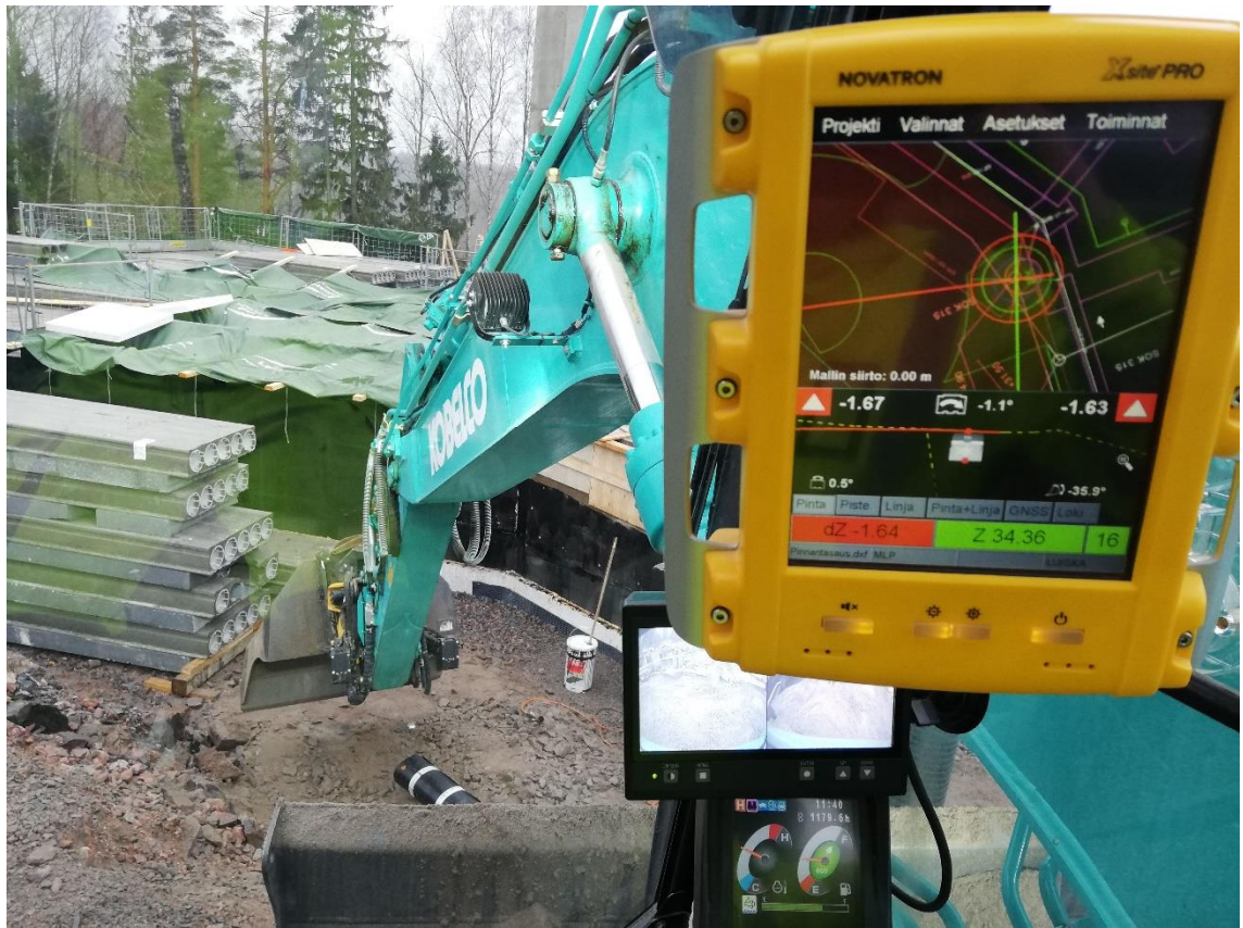
Kuva 7. Koneen kuljettajaa osoittaa pihakaivon sijainnin perämiehelle, kauhan keskipiste (Tiihonen 2019)
