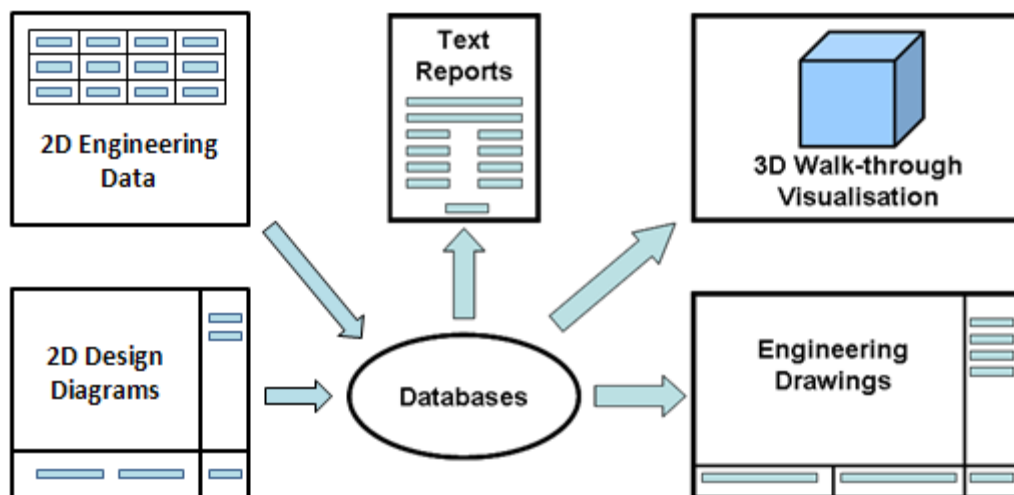
Kuva 5. E3D:n tietokannan toimintaperiaate (AVEVA 2012b.)
