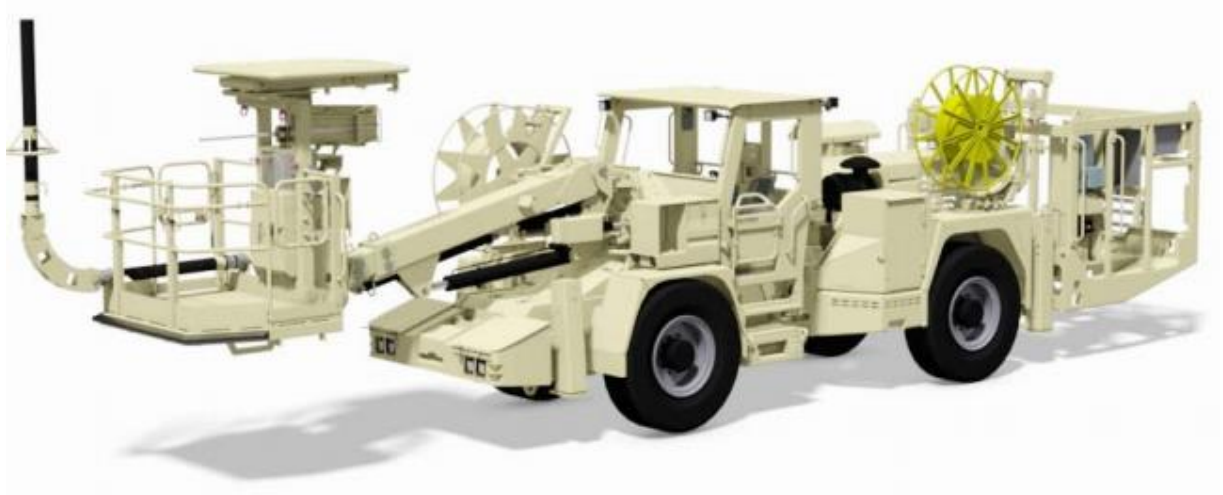
Kuva 5. Charmec LC 605 D(V) on suurikokoinen panostaja keskihytillä. Sen nostokorkeus on 6m ja suurin sallittu nostokuorma 0,5t.
