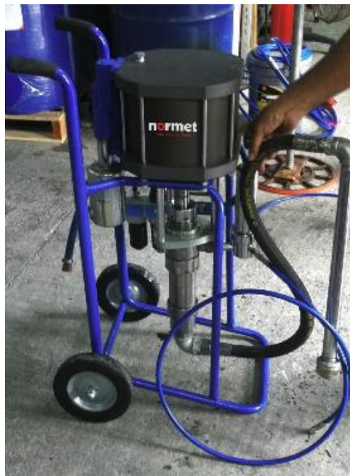
Kuva 6. AP1 Pumppua käytetään tyypillisesti polyuretaani-, epoksi- ja akryylihartsille.
