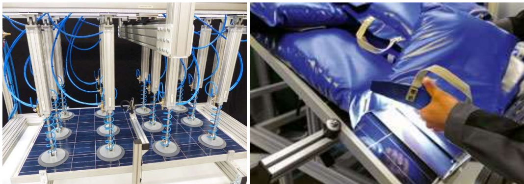
Kuva 8. Mekaanisen kuorman kestävyyttä voidaan testata esimerkiksi paineilmatoimisella imukuppijärjestelmällä (vasemmalla), tai perinteisillä hiekkasäkeillä (oikealla). (iTechworld 2016; PSE AG 2018)
