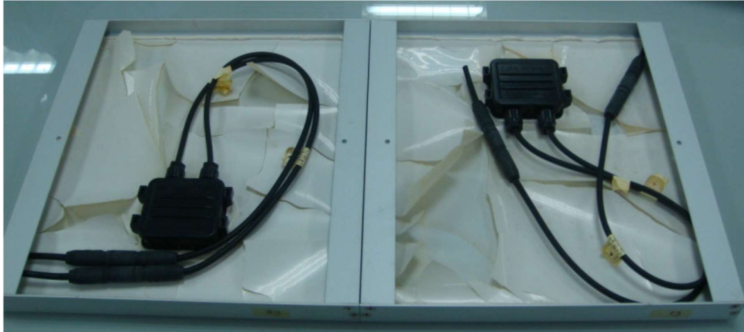
Kuva 6. Aurinkopaneeleja, joiden takakalvo ei ole kestänyt yli 3000 tuntia kostea/kuuma-olosuhdetestin vaatimissa olosuhteissa. (Gambogi 2010)
