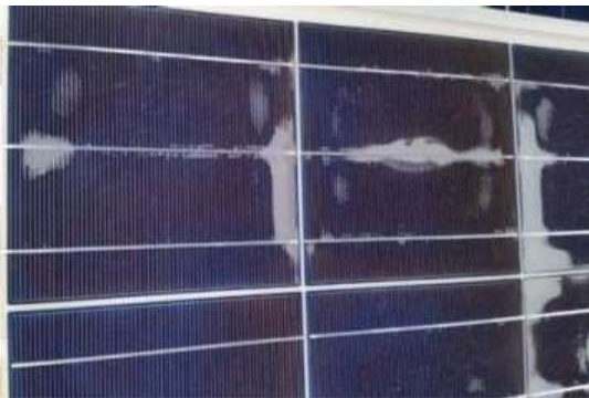
Kuva 3. EVA-kalvon laminointi on pettänyt paikoitellen, mikä on johtanut ilmataskujen syntymiseen. (Hacke ym. 2016)
