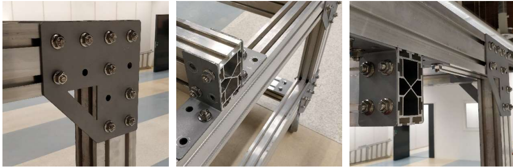
Kuva 14. Laitteeseen suunniteltuja kiinnikkeitä.
