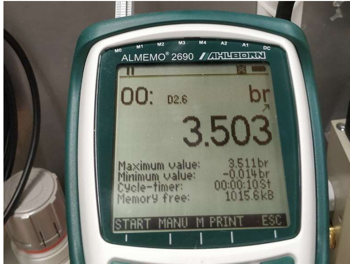
Kuva 19. Mittauksissa käytetty ALMEMO®-tarkkuusmittari.
