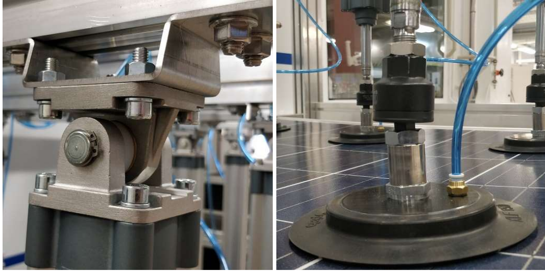
Kuva 15. Sylintereiden ripustuksen sarana vasemmalla ja imukupin pallonivel oikealla.
