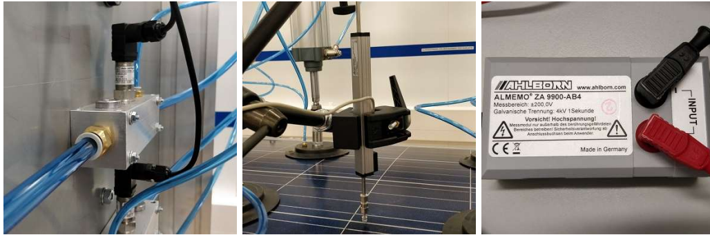
Kuva 20. Testauksissa käytetyt sensorit. Vasemmalta oikealle, painesensori, siirtymäsensori, sekä jännitemittari.
