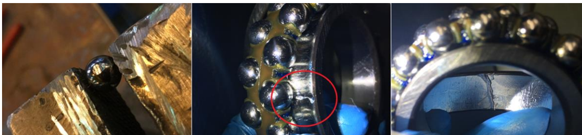
Kuva 16: Laakerikuulan vahingoittaminen, sekä viilto sisä- ja ulkokehään.
