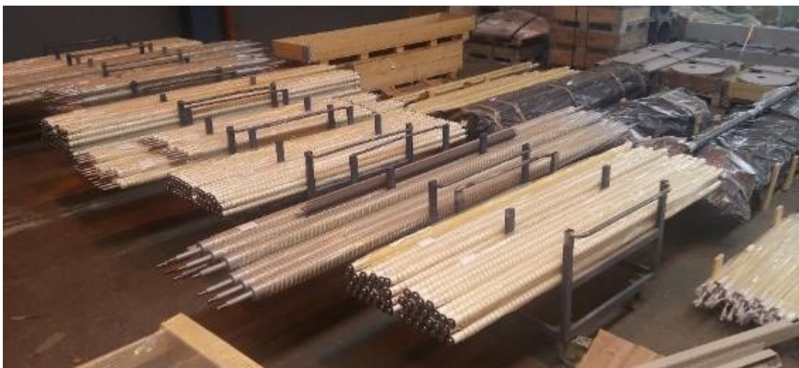
KUVA 19. Lasinkuljetusteloja kärryissä jonossa.
