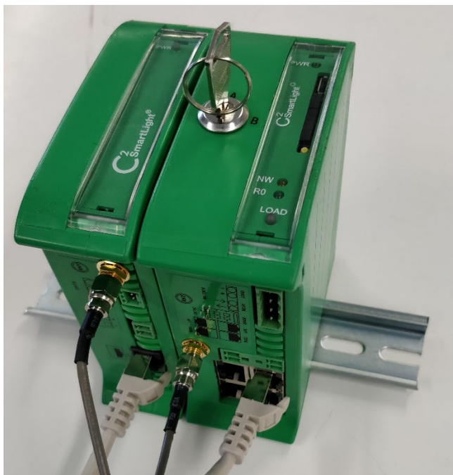
Kuva 30. Valaisinkohtaisen ohjauksen etäohjauksen mahdollistama keskitinlaite.
