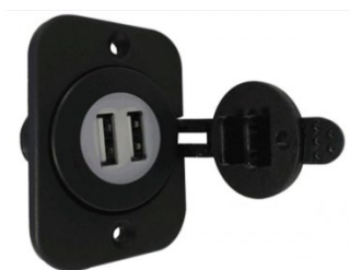
Upotettava 2 x USB-laturi kaikkiin 12 - 24V ajoneuvoihin. Asennus esim. busseihin, auton kojelautaan tai veneeseen. Lähtöjännite: DC 5V/ 3,1A. Suunniteltu matkakäyttöön esim. tabletin tai älypuhelimien kanssa.
