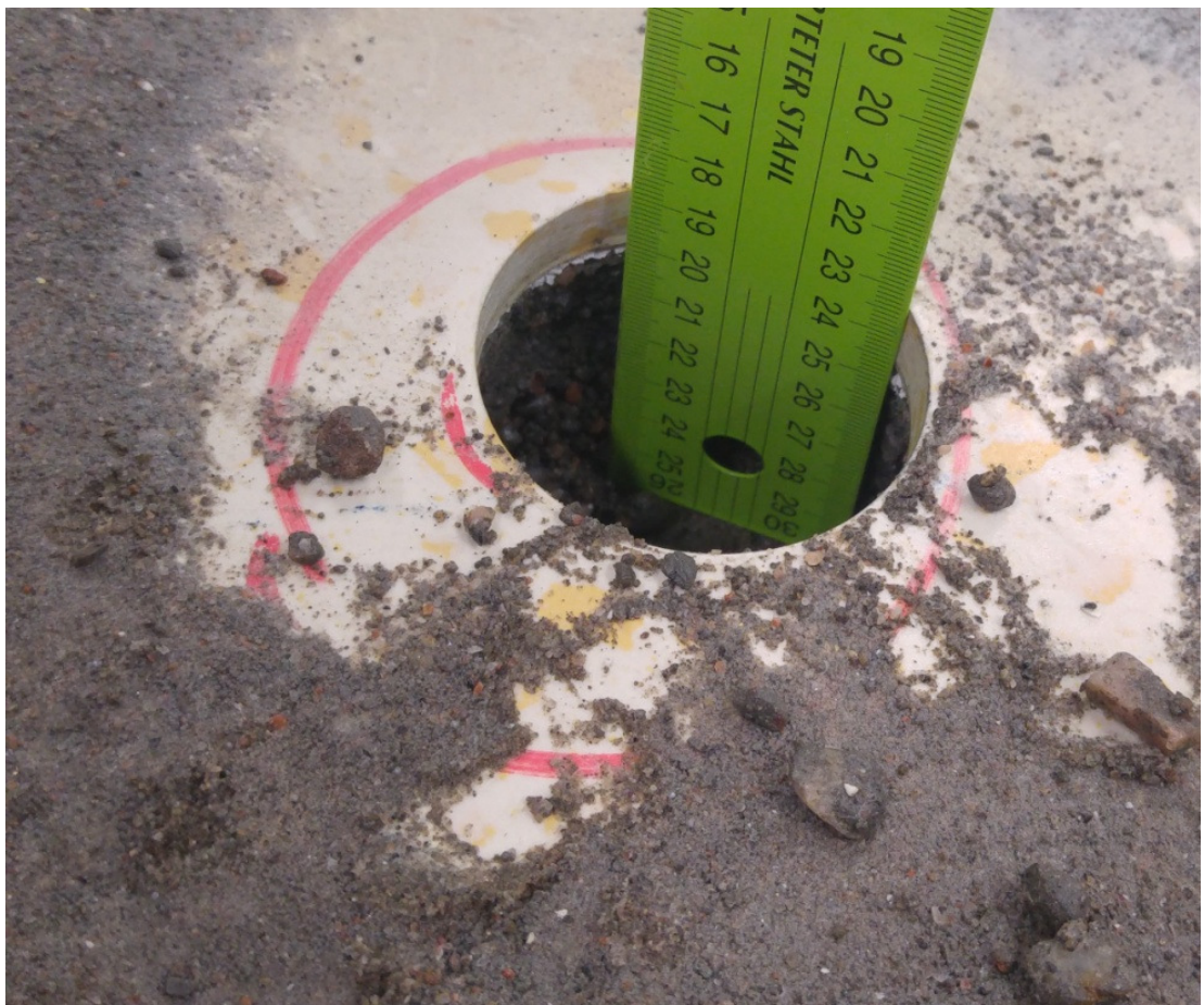
Kuva 18 Epäonnistunut näytteenotto laatikosta 2
