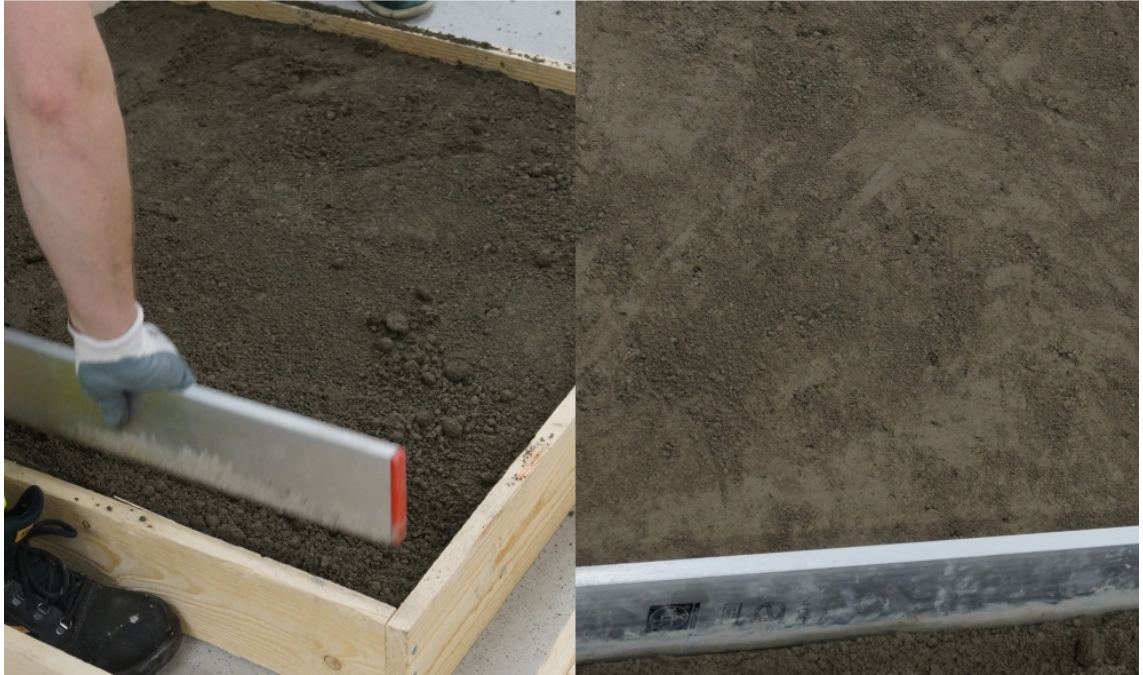
Kuva 2 Pinnan ero massalla ilman filleriä (vasemmalla) ja fillerin kanssa
