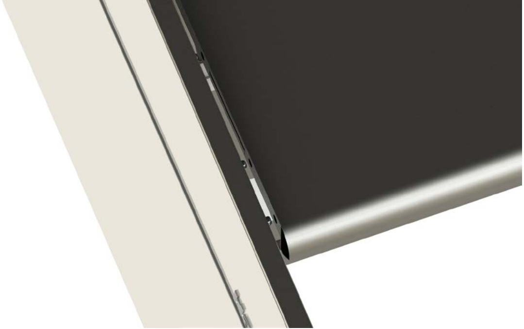
Kuva 30. Rakennetta jäykistävä ja asennusta helpottava tappiliitos (Ryynänen 2017)
