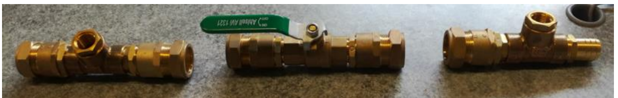
Kuva 26. Liittimet kasattuna. Okun Putkityö Oy.
