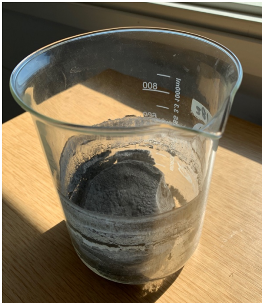
Kuva 4. EPSE Menetelmällä käsitelty tuhkanäyte, jonka koostumus on muuttunut pölyvästä tiiviiksi samalla kun tilavuus on pienentynyt.
