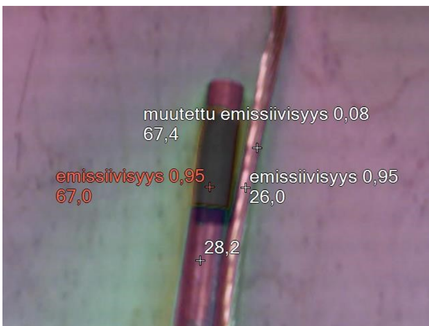
Kuva 19. Kuparin emissiokertoimen määrittäminen lämpökameran avulla.
