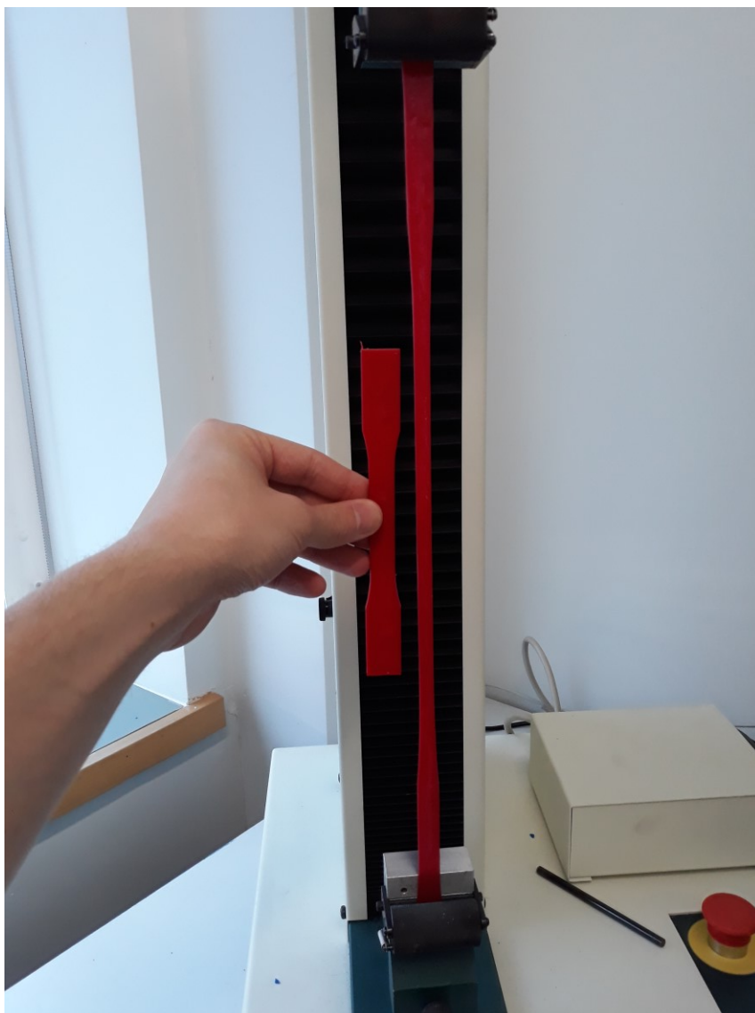
KUVA 10. TPU-näyte venyi moninkertaiseksi eikä katkennut testissä.
