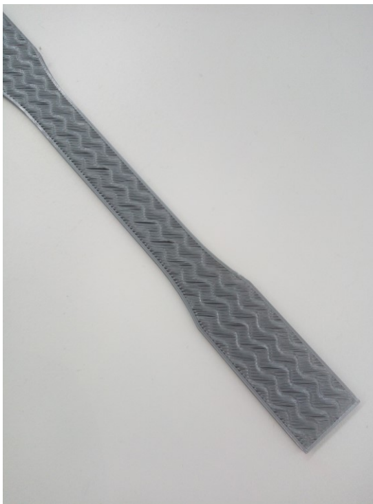
KUVA 4. Täyttökuviota päällikerrosten osalta viimeistelemättömän kappaleen sisällä.
