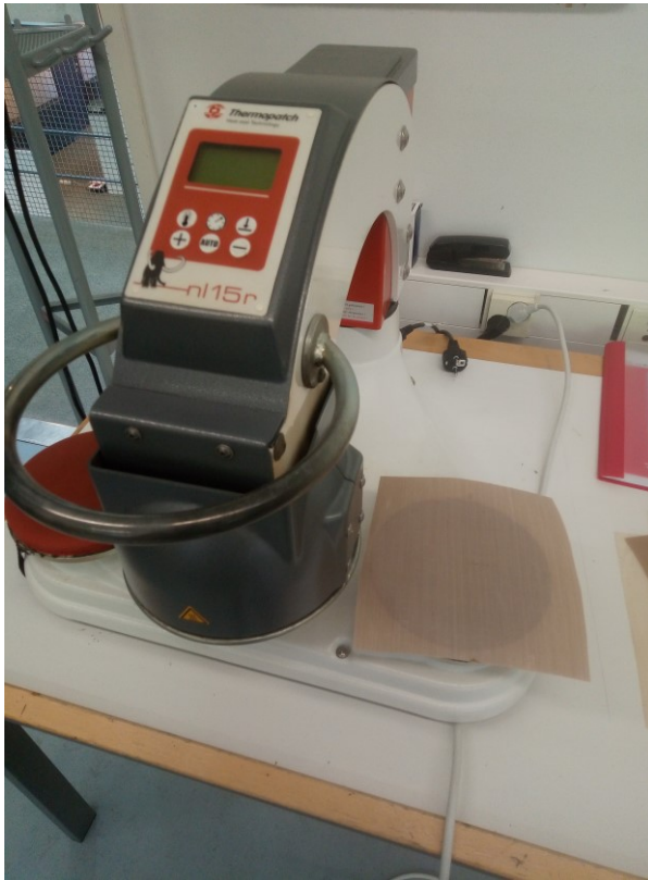
KUVA 14. Työssä käytetty tekstiiliprässi ja näytteen suojana ollut beesi teflonkangaskappale.
