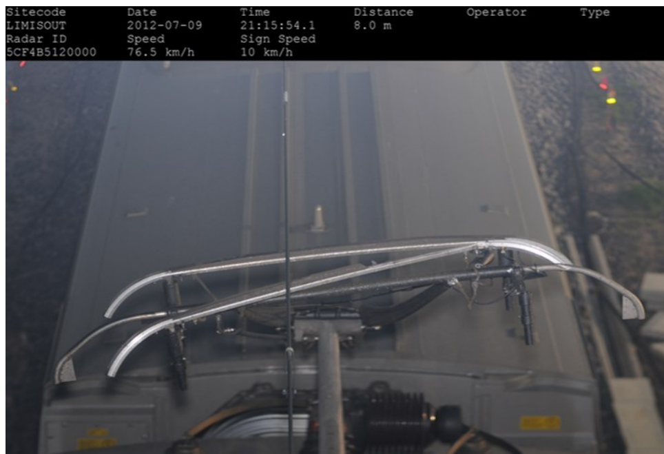
Kuva 2. Massiivisesti vaurioitunut pendolino (SM3) -junan virroitin Limingan APMS-kameran taltioimana. (Väylävirasto, 2012)
