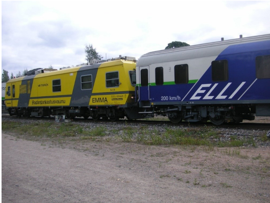
Kuva 5. Radantarkastusvaunut Emma ja Elli. Vaunuista Elli on varustettu monipuolista sähköradan tarkkailua varten (Lentokonefani, 2012)
