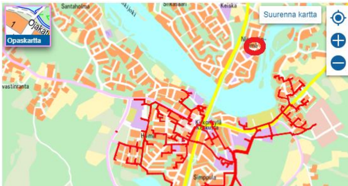
KUVA 10. Kaukolämpöverkosto Haukiputaan alueella. (14).
