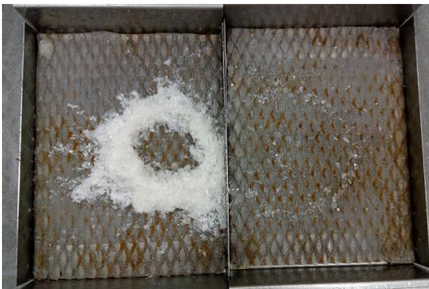
Kuva 11. Polypropeeni murskan erottelun testaus
