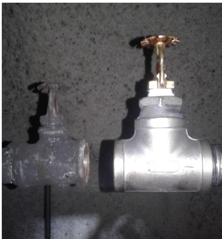
Kuva 5. Vanha, ja uusittu sprinklerisuutin.
