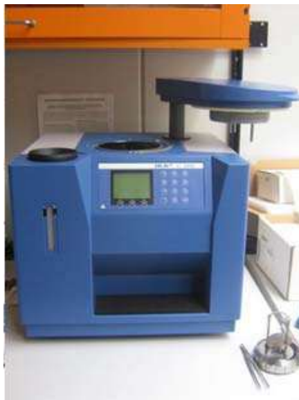
Kuva 4. Lämpöarvojen mittaukseen käytettävä pommikalorimetri.
