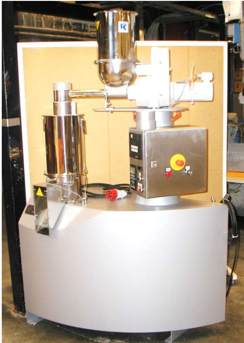
Kuva 2. Oulun yliopiston Kuitu- ja partikkelitekniiikan laboratoriossa sijaitseva pienpelletointilaitteisto, tuotantokapasiteetti 30 kg/h.
