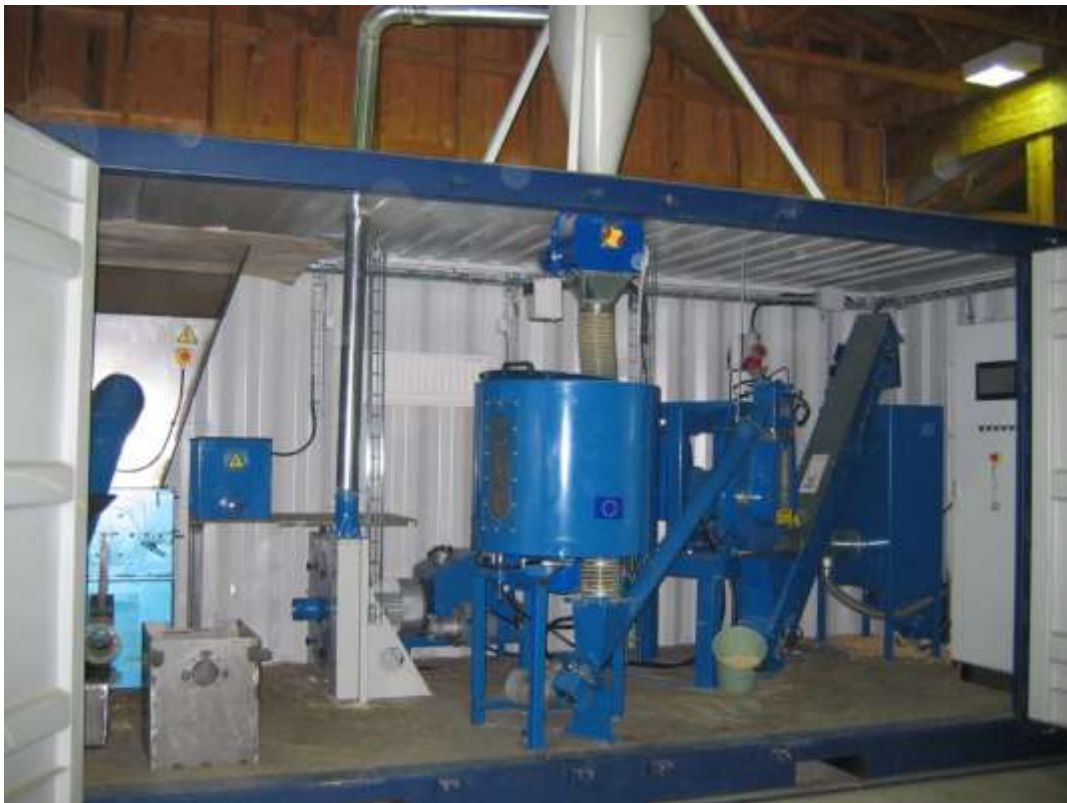
Kuva 1. OAMK LuoVa:n pilot-mittakaavan pelletöintilaitteisto, tuotantokapasiteetti 150 kg/h.
