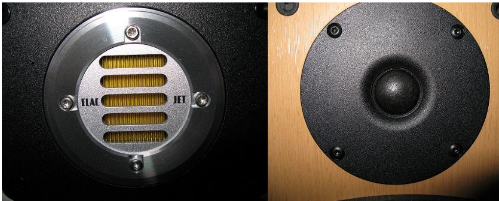
KUVA 9. Elac JET III vs. Jamo-diskantti
