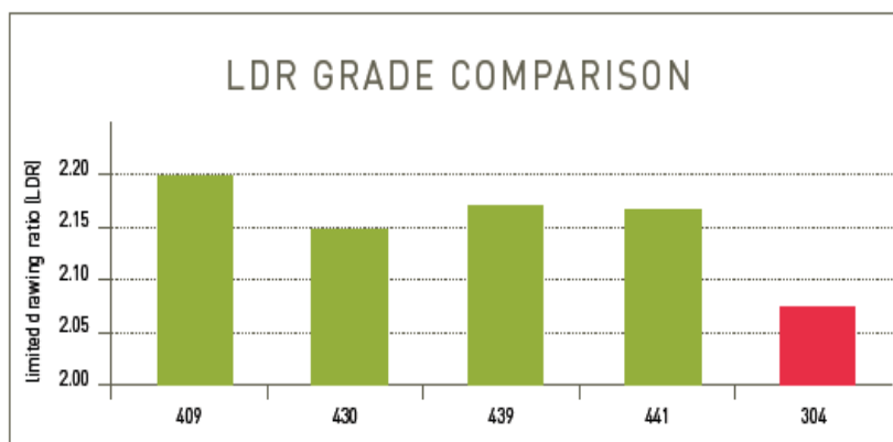
Kuva 24. Ferriittisten ruostumattomien terästen rajavetosuhdearvoja verrattuna austeniittiseen 304 laatuun/14/.
