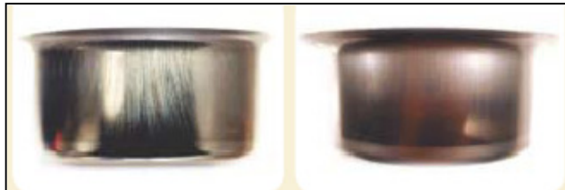
Kuva 21. Roping-pinta verrattuna onnistuneeseen pintaan /14/
