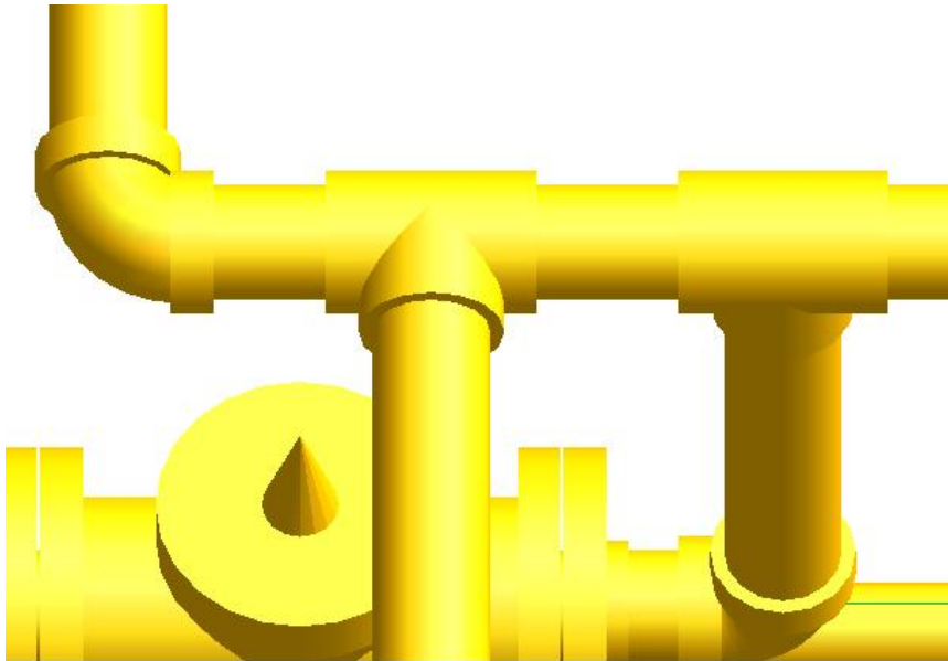
KUVA 34. Mutkan ja t-liitosten välillä näkyvät putken pätkät, joita suunniteltuun laitteistoon ei todellisuudessa tule. (Aveva PDMS 12.0)
