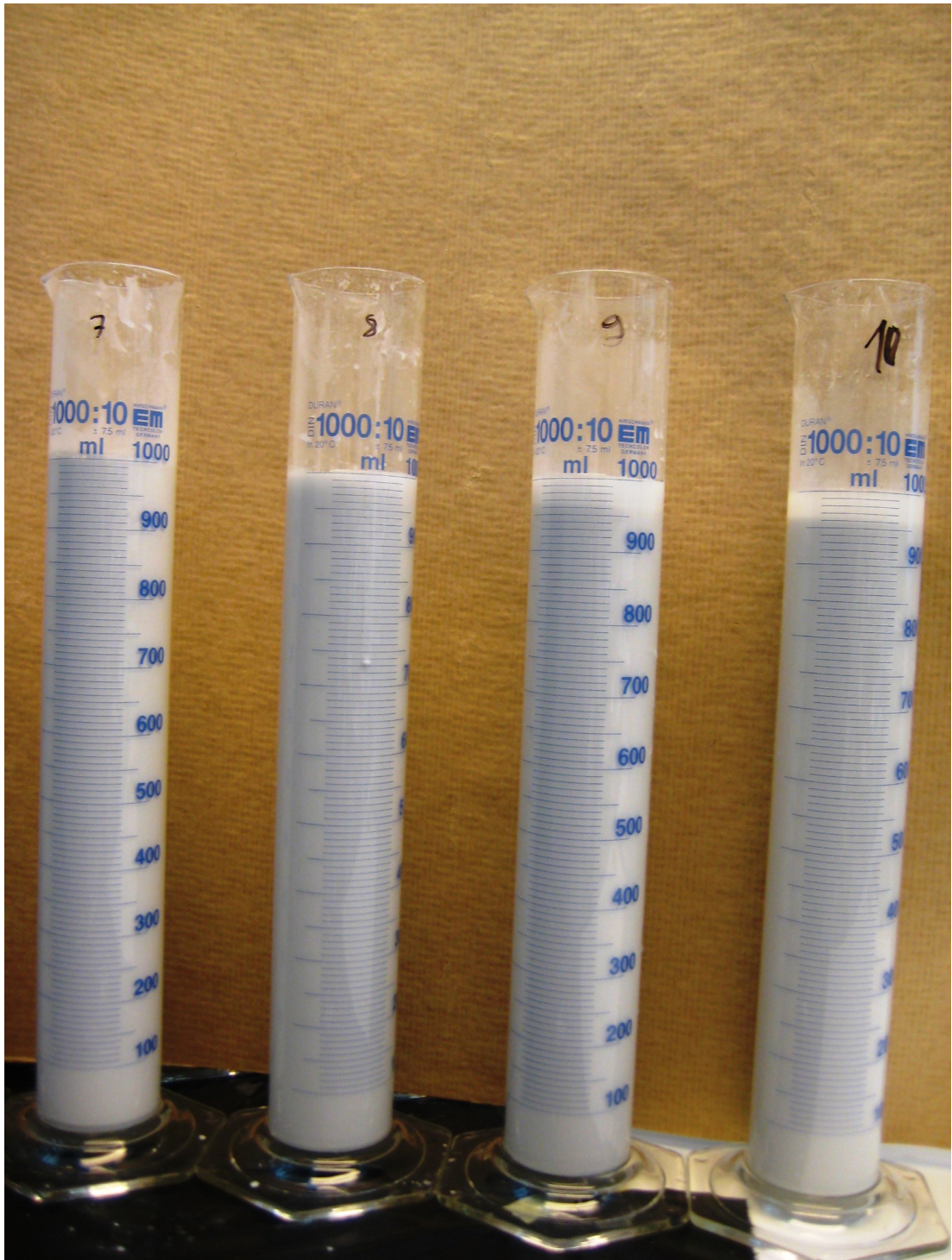
Kuva 14 Koepisteiden 7 - 10 huoneenlämmössä sekoituksen jälkeen
