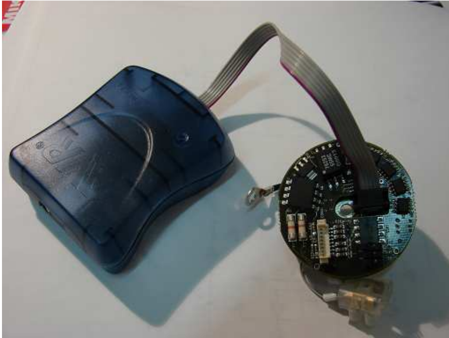
Kuva 10. AVRISP mk II –ohjelmointilaite yhdistettynä Sniffer-piirikorttiin.
