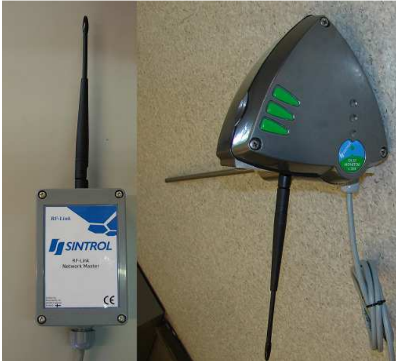
Kuva 21. Master-laite ja hiukkaspitoisuusmittari.
