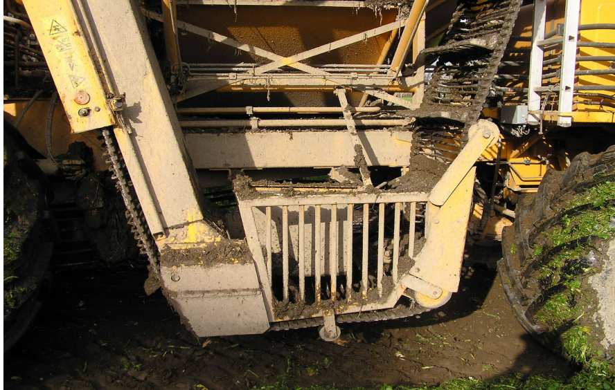
KUVA 14 Kleine vasemmalta sivulta, säiliön täyttölevaattori. (Markula 2007)
