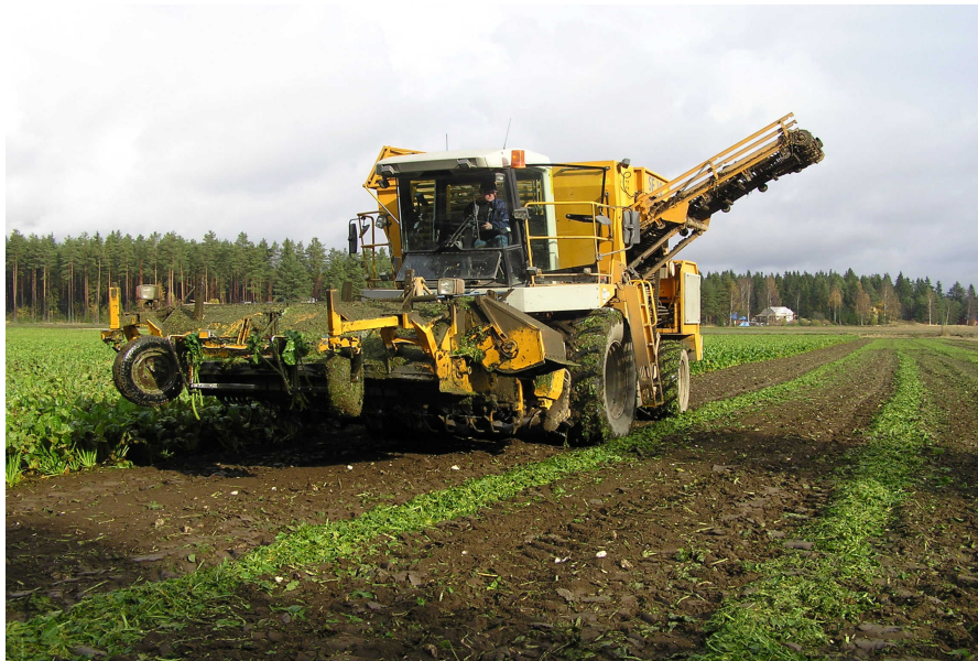
KUVA 2 6-rivinen Kleine SF 10, itsekulkeva juurikkaan nostokone (Markula 2007)
