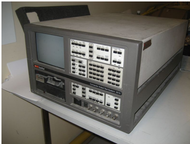
KUVIO 15. Genrad Computer-Aided Test System2515-analysaattori.
