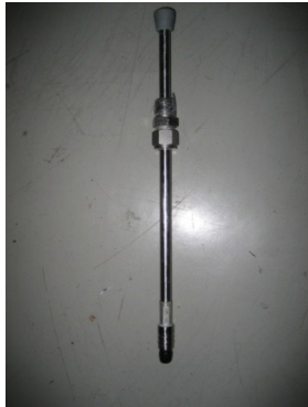
Kuva 1. Dynaamista painetta mittaava anturi.
