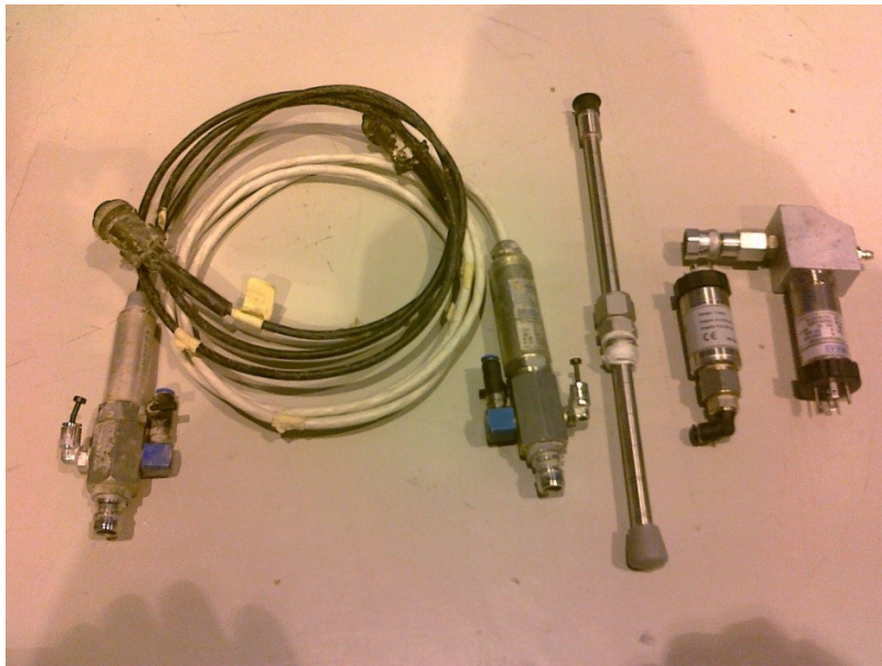
KUVIO 11. Staattisen - ja dynaamisen paineen mittaamiseen tarkoitettuja antureita.
