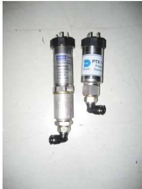
Kuva 1. Staattista painetta mittaavia antureita.
