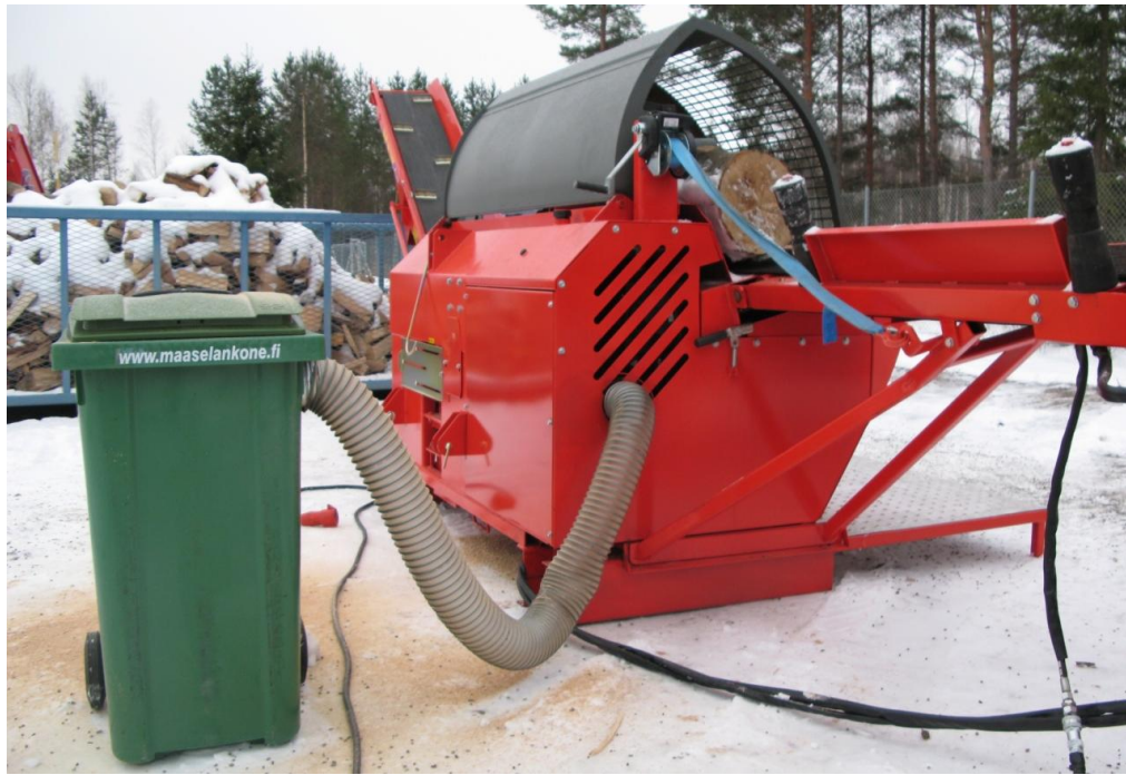
KUVIO 31. Isossa BIG X 50 -klapikoneessa on sisäänrakennettu puruimuri.
