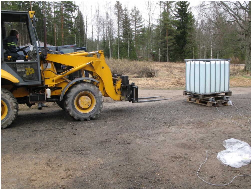
KUVIO 23. Traktorin hydraulikkaöljyn paineesta mittaavan vaa'an tulosta verrattiin palkkivaaka'an tulokseen.
