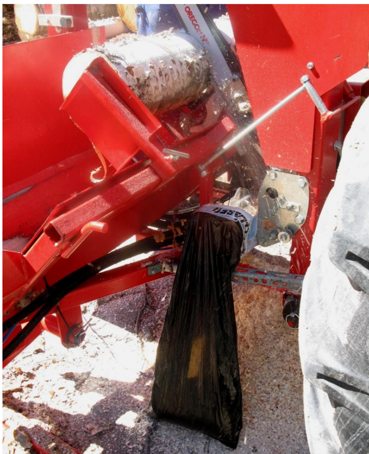
KUVIO 14. Muovipussista ja -kanisterista valmistettu purunkerääjä Pilke Masterissa
