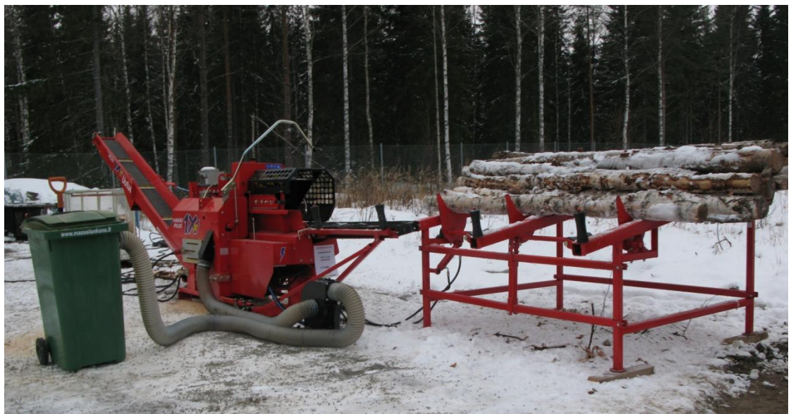
KUVIO 32. Hakki Pilke -klapikoneen ulkopuolinen puruimuri
