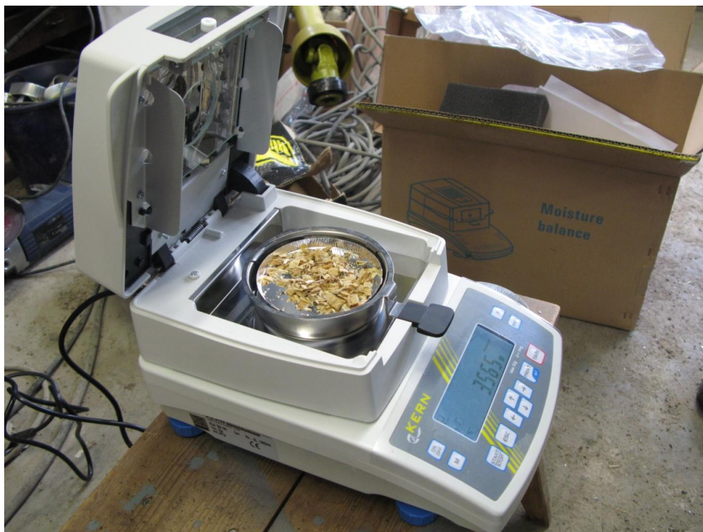
KUVIO 18. Purunäyte Kern MLB 50 -kosteusanalysointilaitteen vaa'alla
