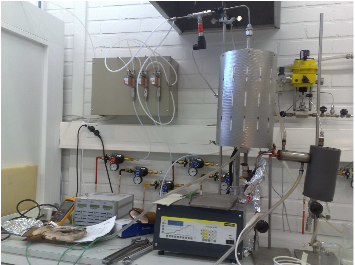
KUVIO 2. Putkiuuni, jolla suoritettiin hiilen fysikaalinen aktivointi
