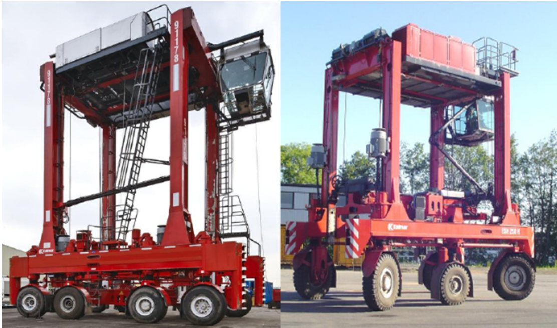
Kuvio 3: Kalmarin kontinkäsittelylaitteet ESC ja SHC (SC summary R&D meeting 17.12.2010 / Jari Karjalainen)
