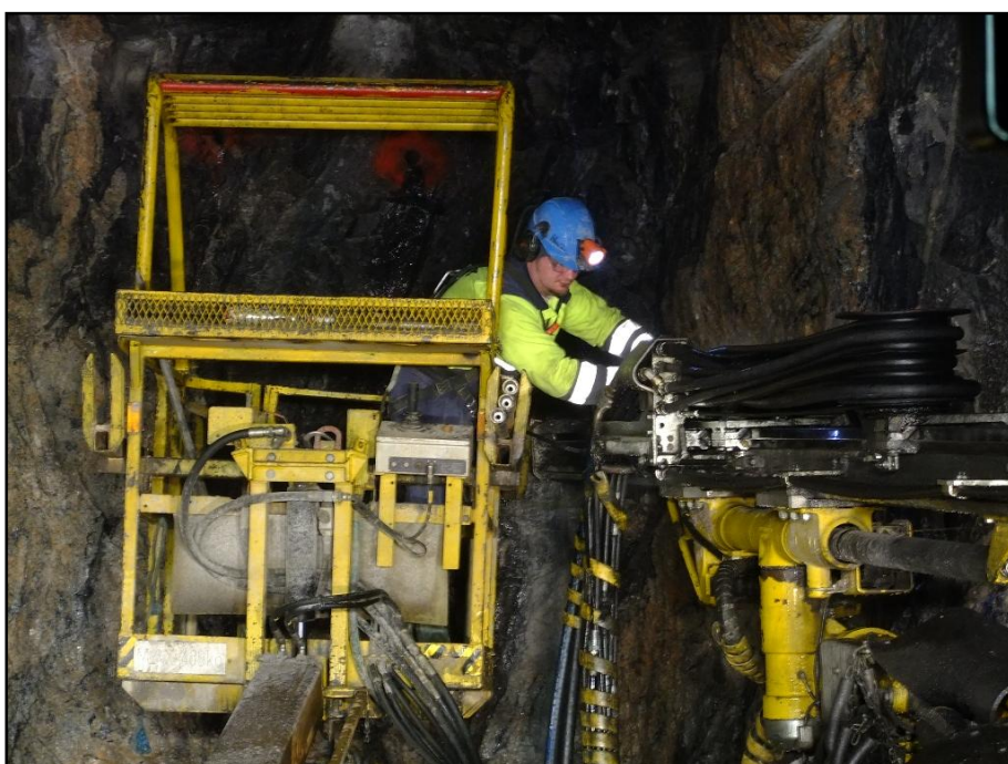
Kuva 37. Jatkotankoporausta, jossa kangenvaihto suoritetaan miesvoimin. Vaatii suurta huolellisuutta niin kankimieheltä kuin porariltakin.
