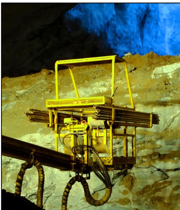
Kuva 42. Porajumbon henkilönostokori, jossa suojakatos. Jatkotankotelineet kunnossa. Korissa ei ylimääräistä roinaa.
