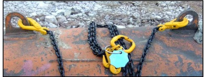
Kuva 7. Hyväkuntoiset kettinkiraksit, joissa merkintälevy suurimmasta sallitusta kuormasta → oikeinhavainto.
