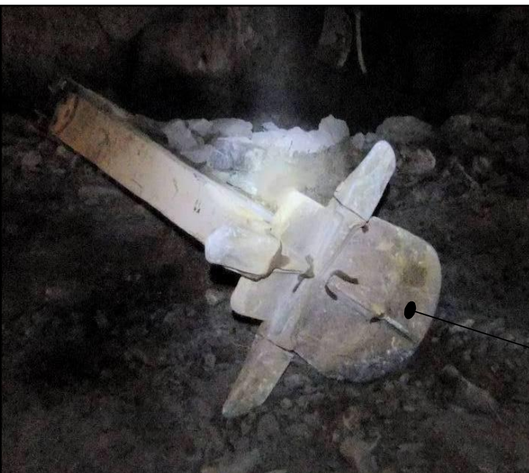
Kuva 34. Tällä osalla rusnataan katto ja kainalopinnat – ei soveltuva väline. Vaikka kestävyys varmasti parantunut...
