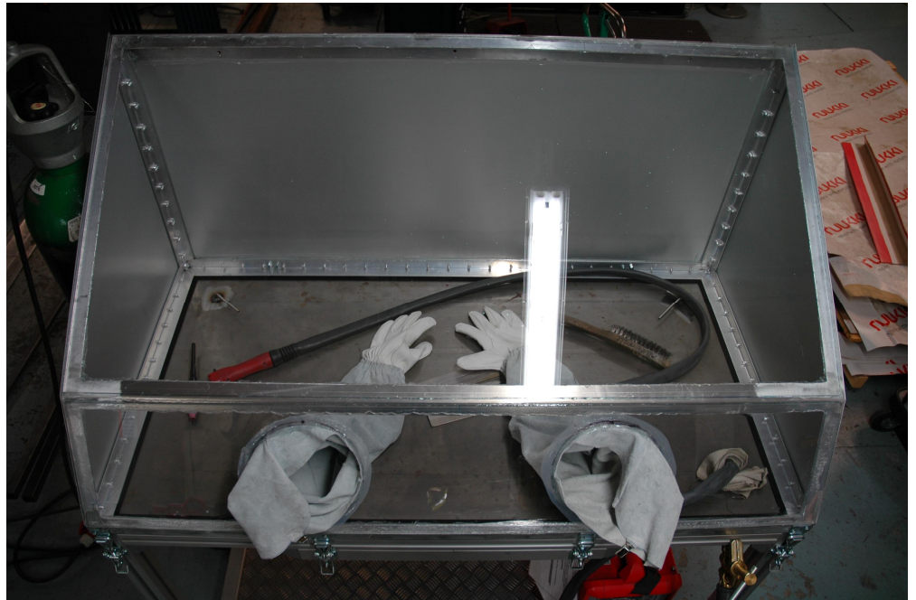
Kuva 12. Hitsauskammion argonsuuttimet näkyvät työtason takakulmissa.
