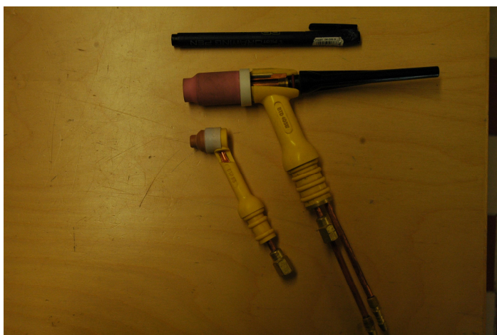
Kuva 3. Vesijäähdytetty TIG-poltin ja pienille virroille tarkoitettu pieni poltin.
