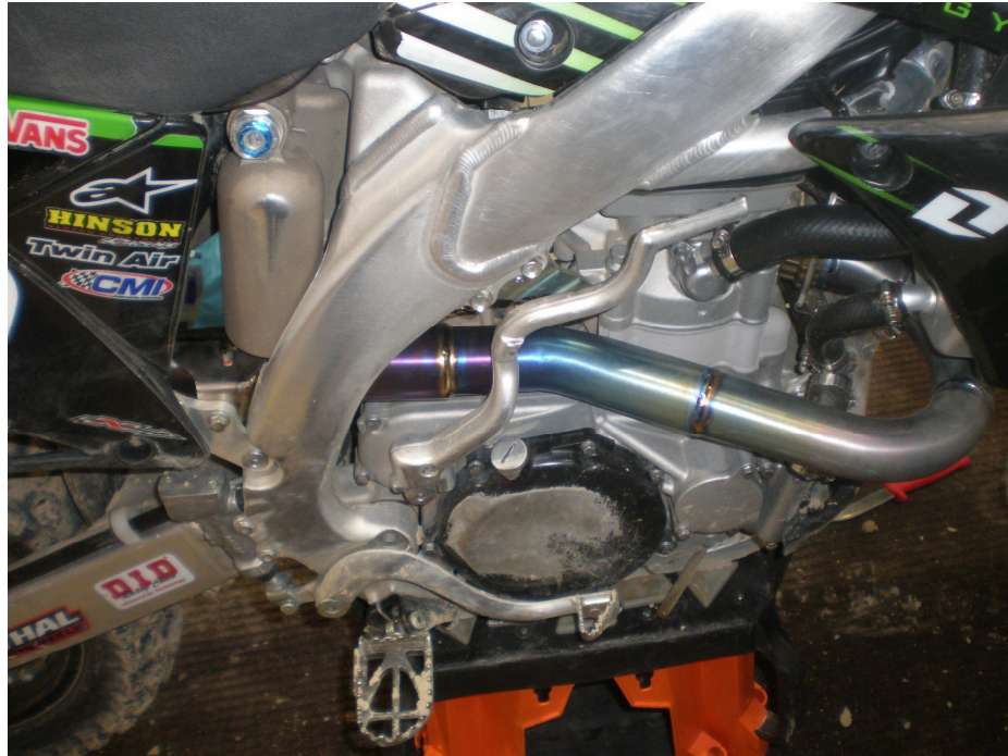
Kuva 16. Motocrosspyörän titaaninen pakoputki. Sinertävä ja purppurainen väri syntyy, kun putki kuumenee ja titaani reagoi ilman kaasujen kanssa.
