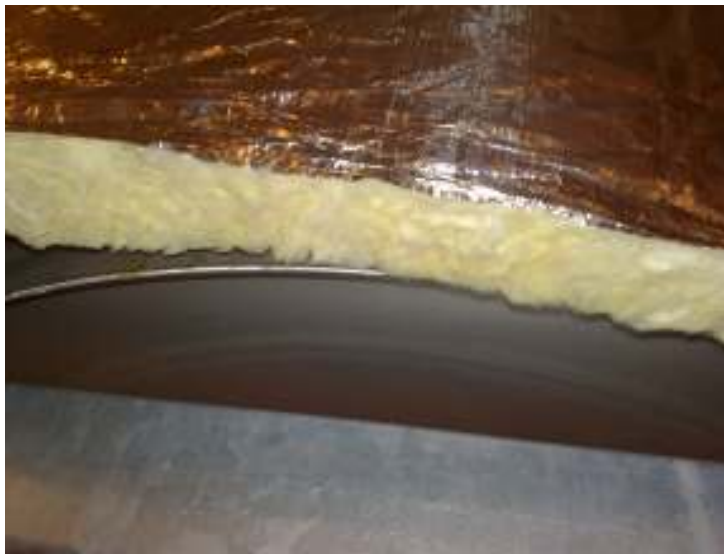
KUVIO 16. Lähikuva lysimetrien lasivillaeristeestä. (Ryynänen 2010.)
