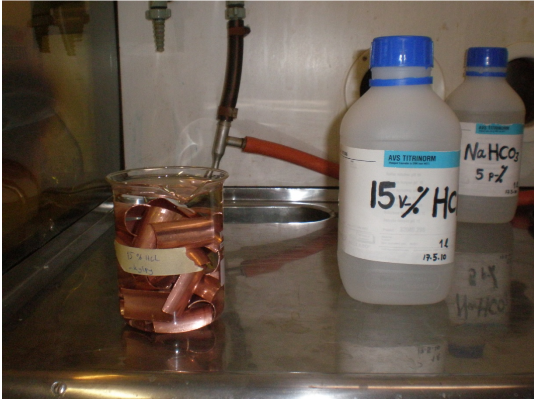
KUVIO 11. Kuparikuponnit peseytymässä suolahapossa (Kuva: Tapani Latvala 2010)
