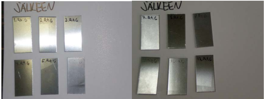
KUVIO 44. Ruostumaton teräs kuuden tunnin kylpyjen jälkeen kaikissa liuoksissa (Kuva: Tapani Latvala 2010)
