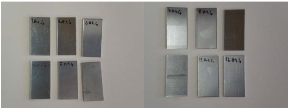
KUVIO 46. Haponkestävä teräs kuuden tunnin kylpyjen jälkeen peittauskemikaaleissa 1–12 (Kuva: Tapani Latvala 2010)
