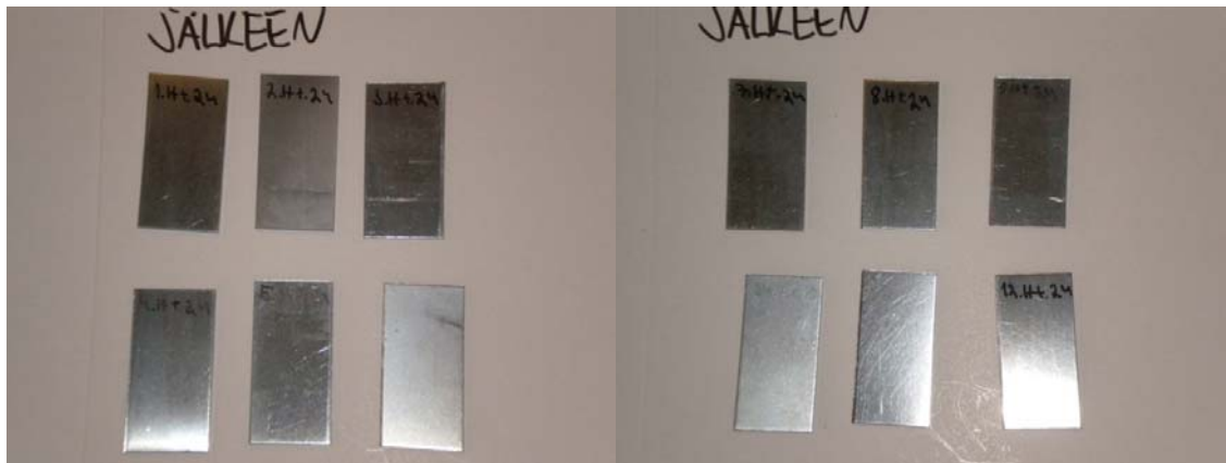
KUVIO 47. Haponkestävä teräs 24 tunnin kylpyjen jälkeen kaikissa peittauskemikaaleissa (Kuva: Tapani Latvala 2010)
