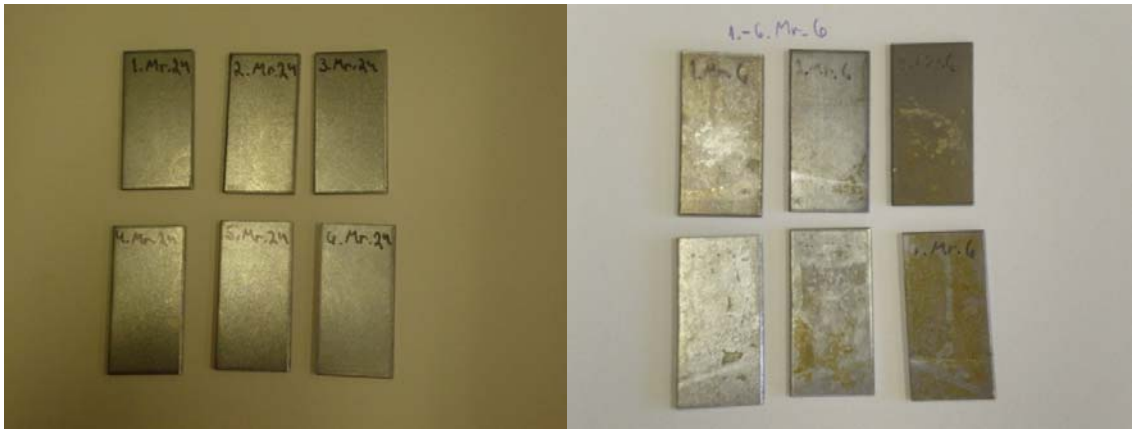
KUVIO 51. Mustarauta ennen ja jälkeen kuuden tunnin reaktion peittauskemikaaleissa 1–6 (Kuva: Tapani Latvala 2010)
