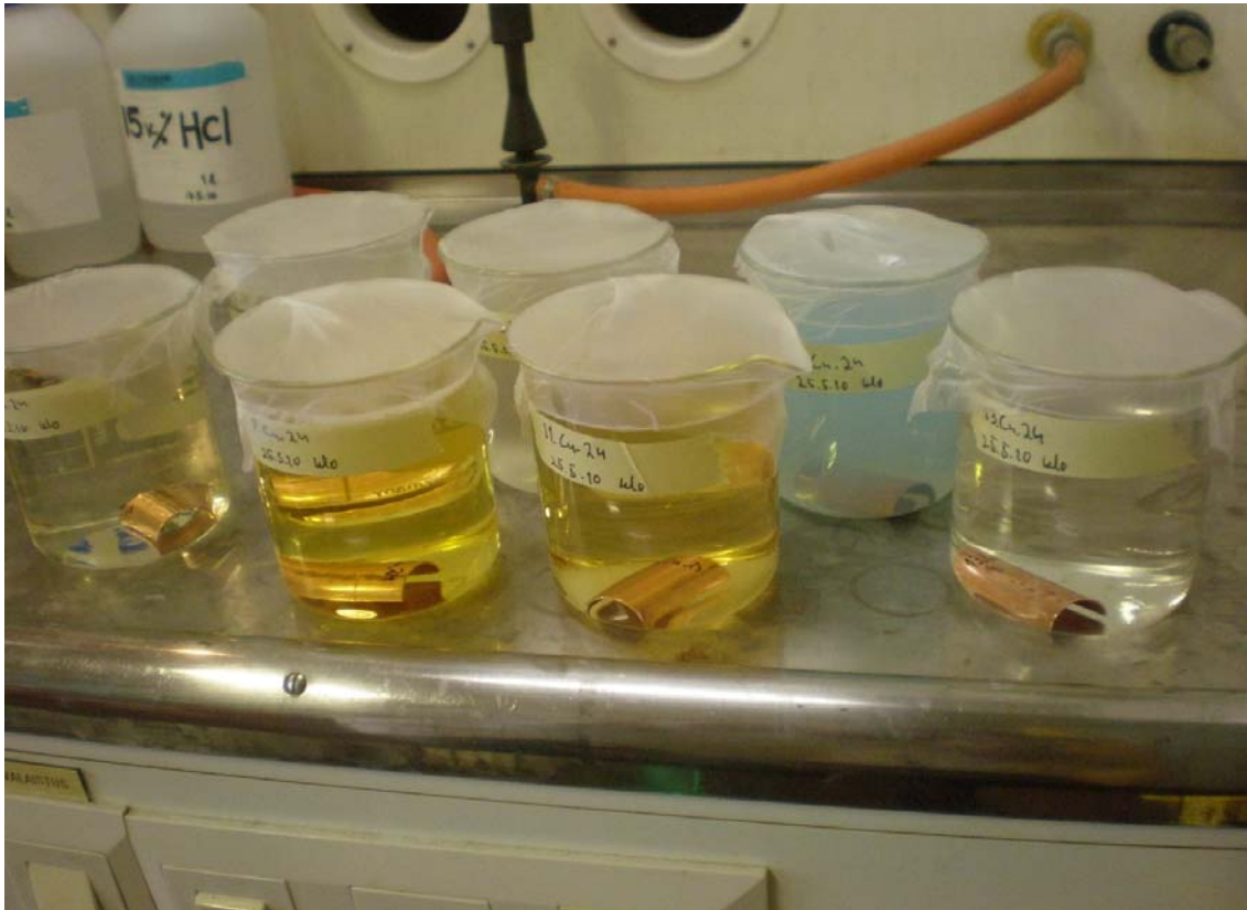
KUVIO 13. Kupariset korroosiokupongit peittauskemikaaleissa vuorokauden reaktioajalla (Kuva: Tapani Latvala 2010)
