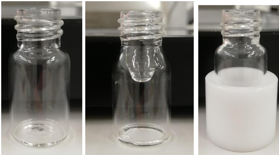
Kuva 2 LEIMA3 -linjalla annosteltavat pullot: 3 ml pullo ja 500 \mu l sisäpullo. Pullojen kaatumisen ehkäisemiseksi linjalla on käytössä pulloille tarkoitetut poketit, josta esimerkki näkyy kuvassa oikealla.
