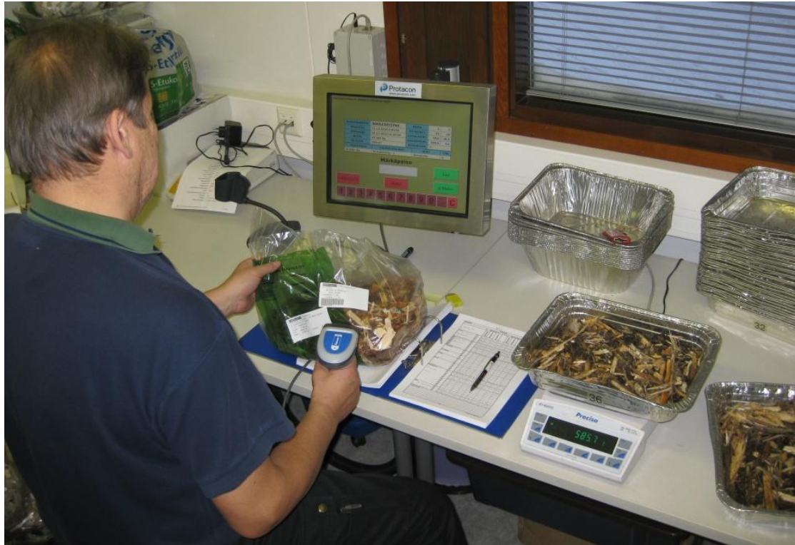
KUVA 5. Päivittäisten polttoaineiden kosteuksien mittaamista Kotkan Energia Oy:n omassa polttoainelaboratoriossa.
