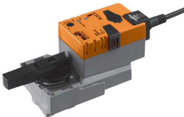
Kuva 6. Belimon venttiilimoottori LRQ24A-SR, jossa ajoaika 90°:n kulmalle on 9 sekuntia. [8.]
