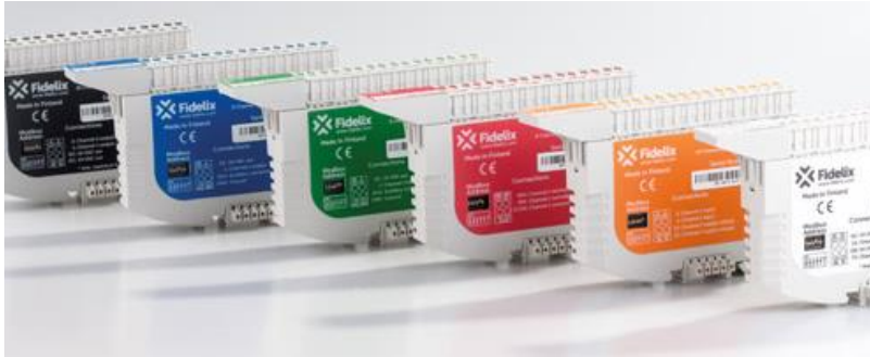
Kuva 11. Fidelix Oy:n Compact-sarjan I/O-moduulit. [14.]
