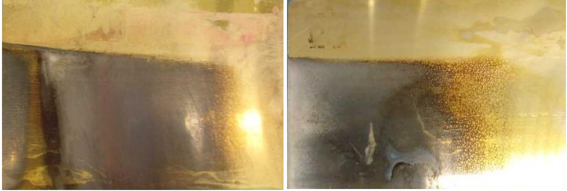
Kuva 17. Kuvassa oikeanpuoleinen pinnoite saostettiin sulfaattikylvyllä ja vasemmanpuoleinen pinnoite saostettiin glysiinikylvyllä.
