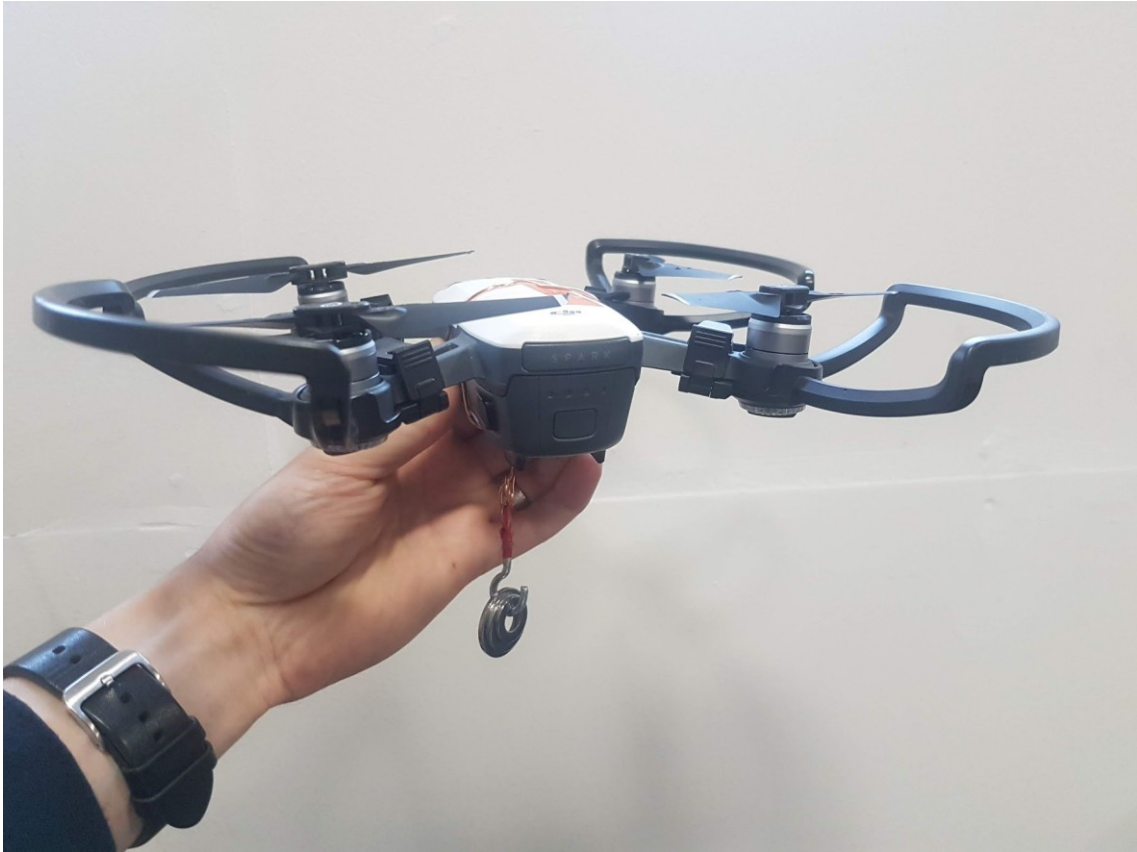
KUVA 5. Ulkona käytetty ratkaisu hyötykuorman kuljettamiseen.
