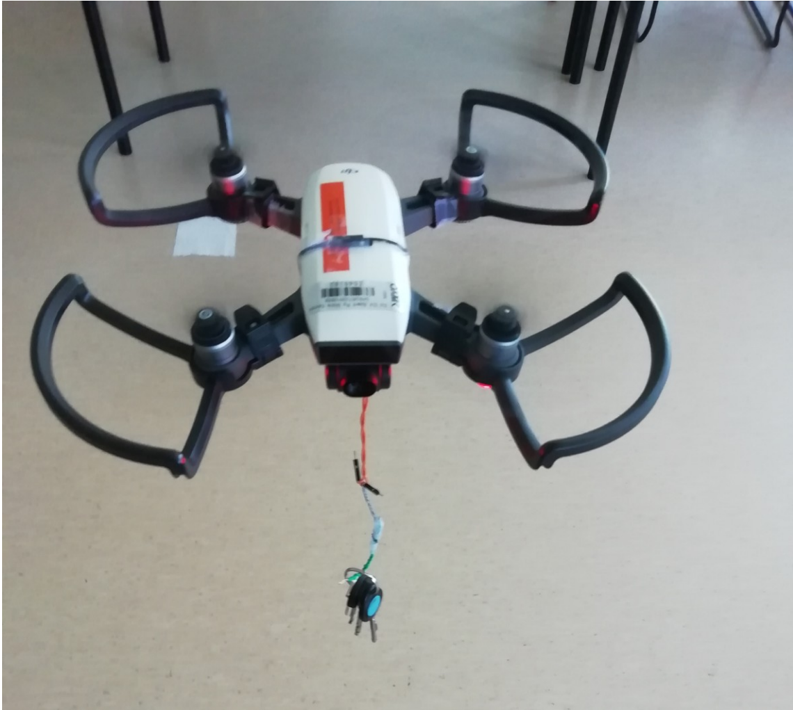
KUVA 3. Testilennoissa käytetty hyötykuorman sidontapatentti.
