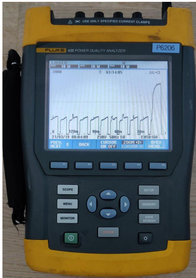
Kuva 9. Sähkönlaatu- ja energia-analysaattori Fluke 435
