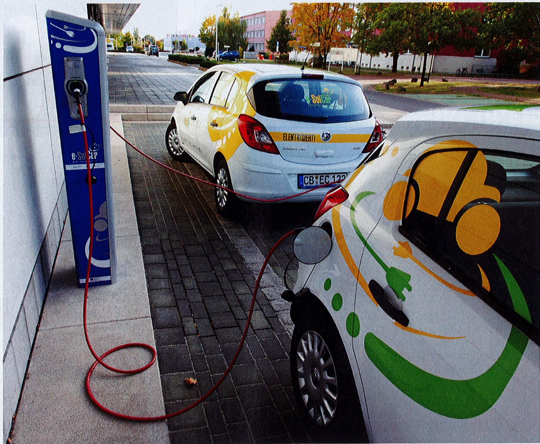
Pikalatureissa hyödynnetään jo nyt älykäästä kuormantasausta: lataustehoa pudotetaan helposti äkillisissä verkon kulutushuipussa.
