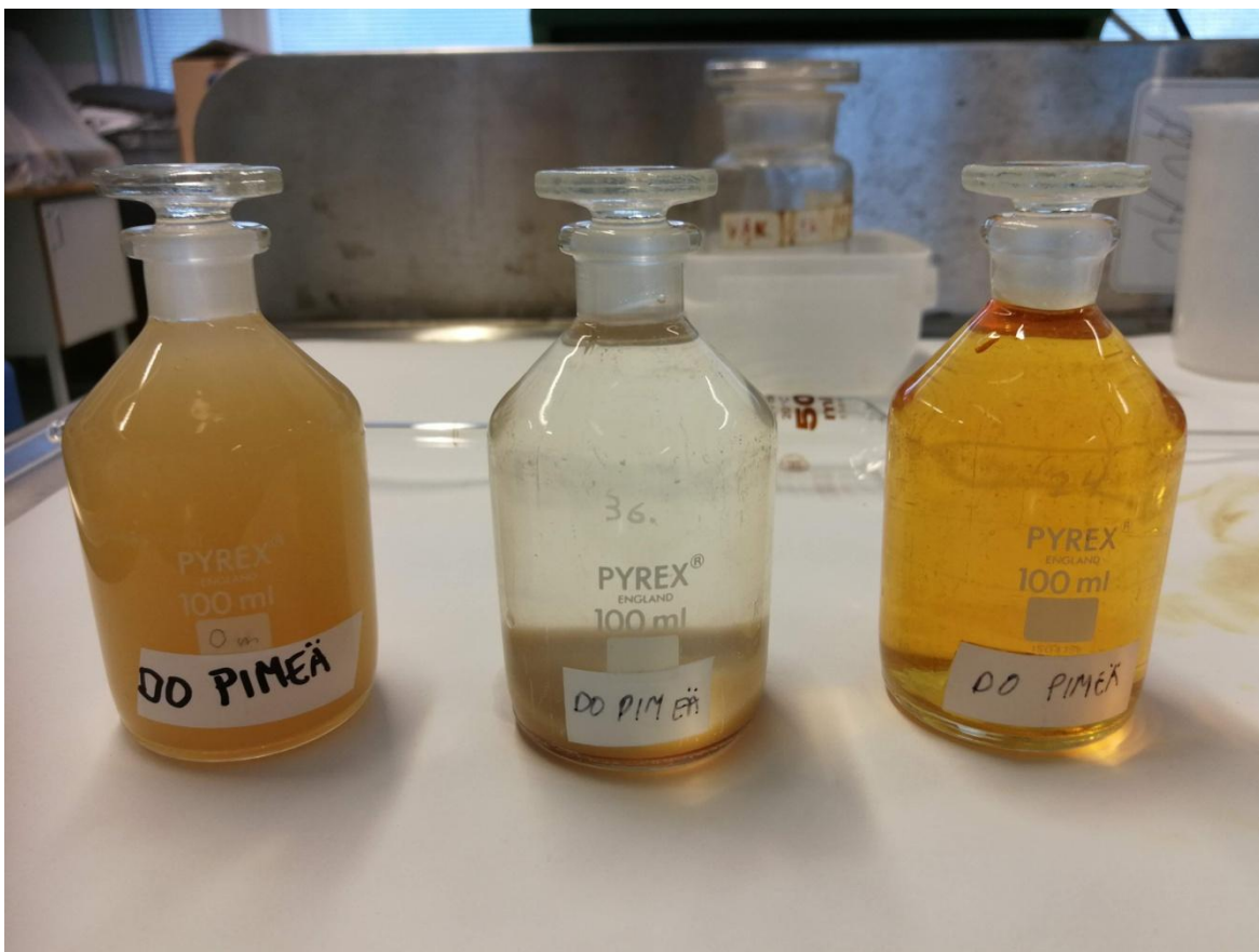
Kuva 2. Liukoisen hapen määrittämisessä käytetty jodometrinen menetelmä
