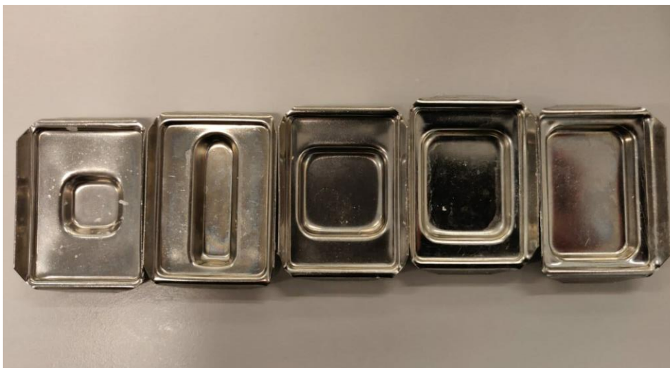
Kuva 2: Valamiseen käytettäviä metallimuotteja. (Virolainen 2019.)
