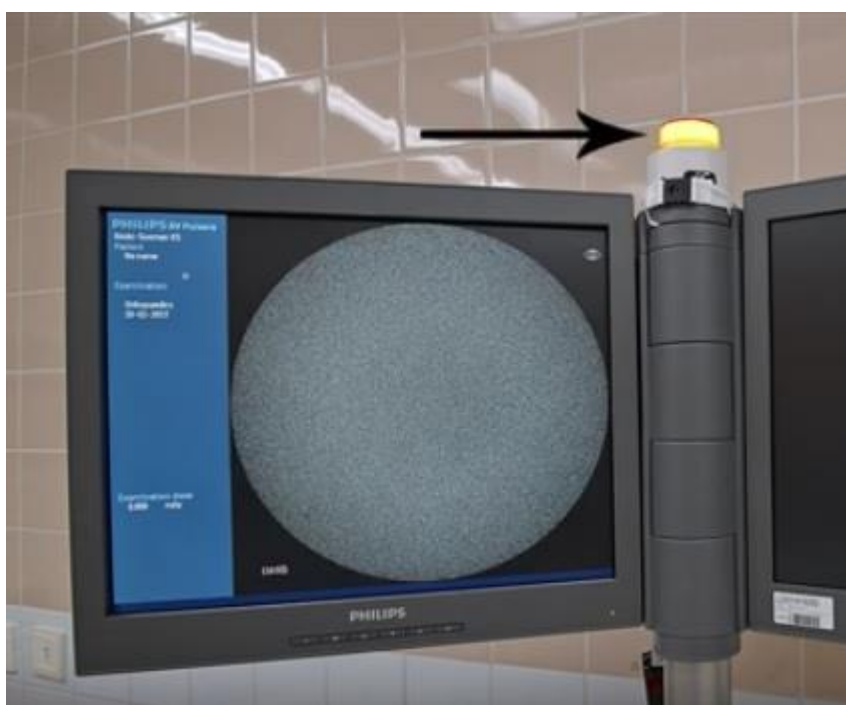
KUVA 2. Säteilyn tuoton merkkivalo monitoriyksikössä (Kuva: Jani Pyykkönen 2019)
