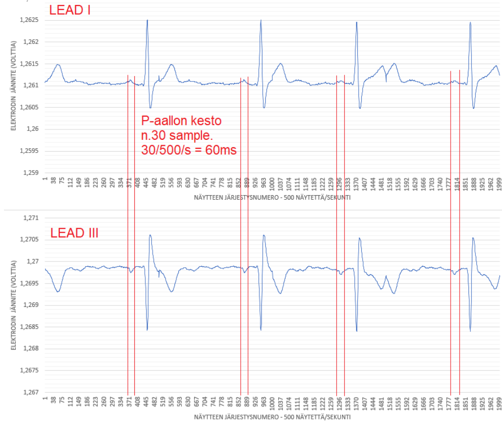
Kuva 31. P-aallon keston määrittäminen Lead 1- ja Lead 3-kanavien datasta.
