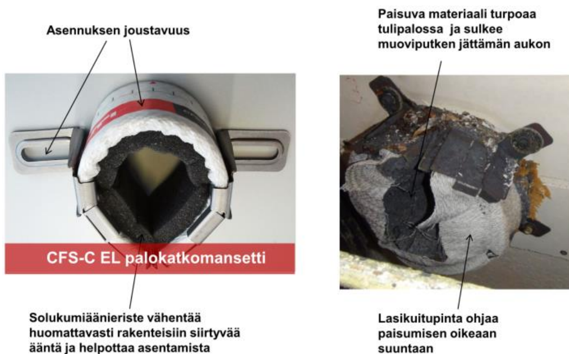
Kuva 11. Palokatkomansetti palotilanteen jälkeen. (kuva Hiltin koulutusmateriaalista)
