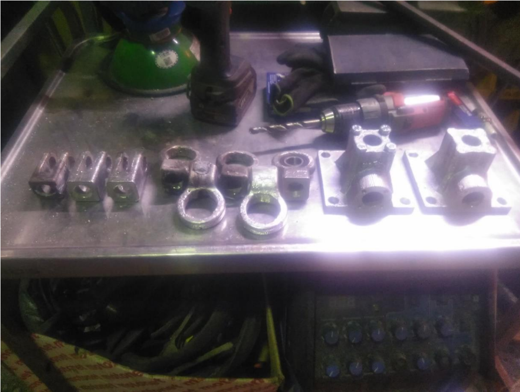
KUVA 26. Kaikki valetut osat koneistettuna
