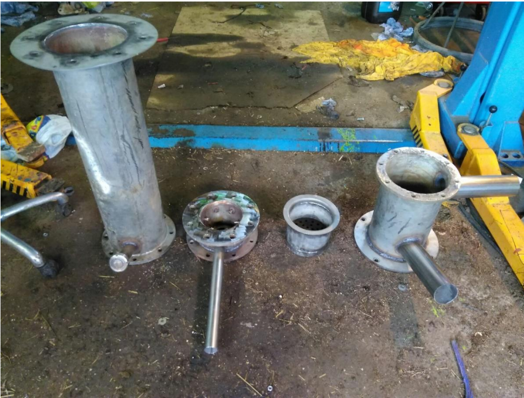
KUVA 13. Häkäpöntön osat vasemmalta oikealle: polttoainesäiliö, tulipesä, arina ja tuhkatila
