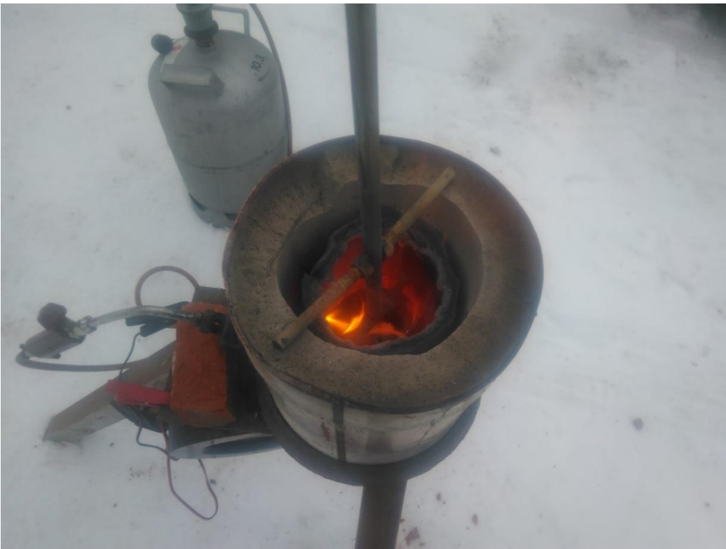
KUVA 23. Alumiinin sulatus nestekaasuahjossa
