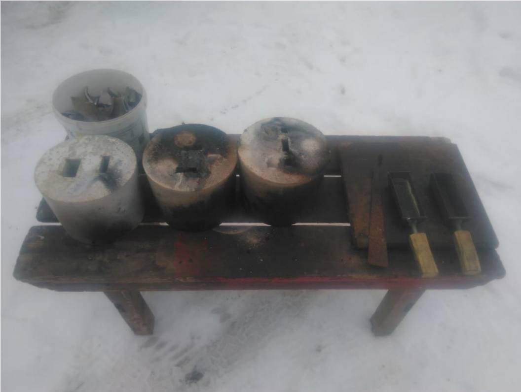
KUVA 22. Muotit valmiina metallivalua varten
