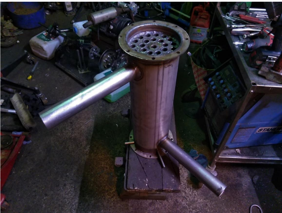
KUVA 49. Valmis paloilman esilämmittimen lämmönvaihdin
