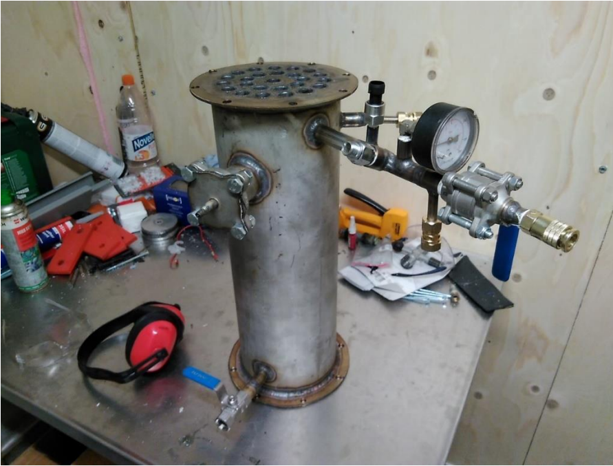
KUVA 53. Hörykattilan vuototestausta paineilmalla
