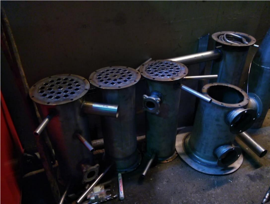
KUVA 52. Kaikki lämmönvaihtimet valmiina
