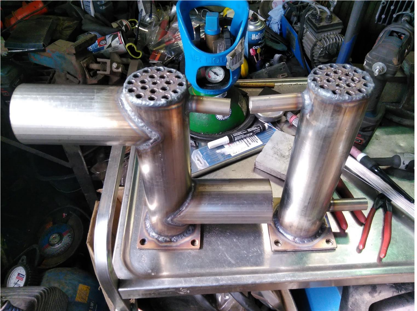
KUVA 33. Vasemmalla kuuma lämmönvaihdin, oikealla kylmä
