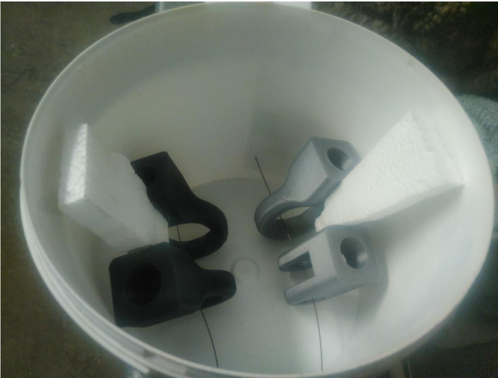
KUVA 20. Mallit ennen betoniin valamista
