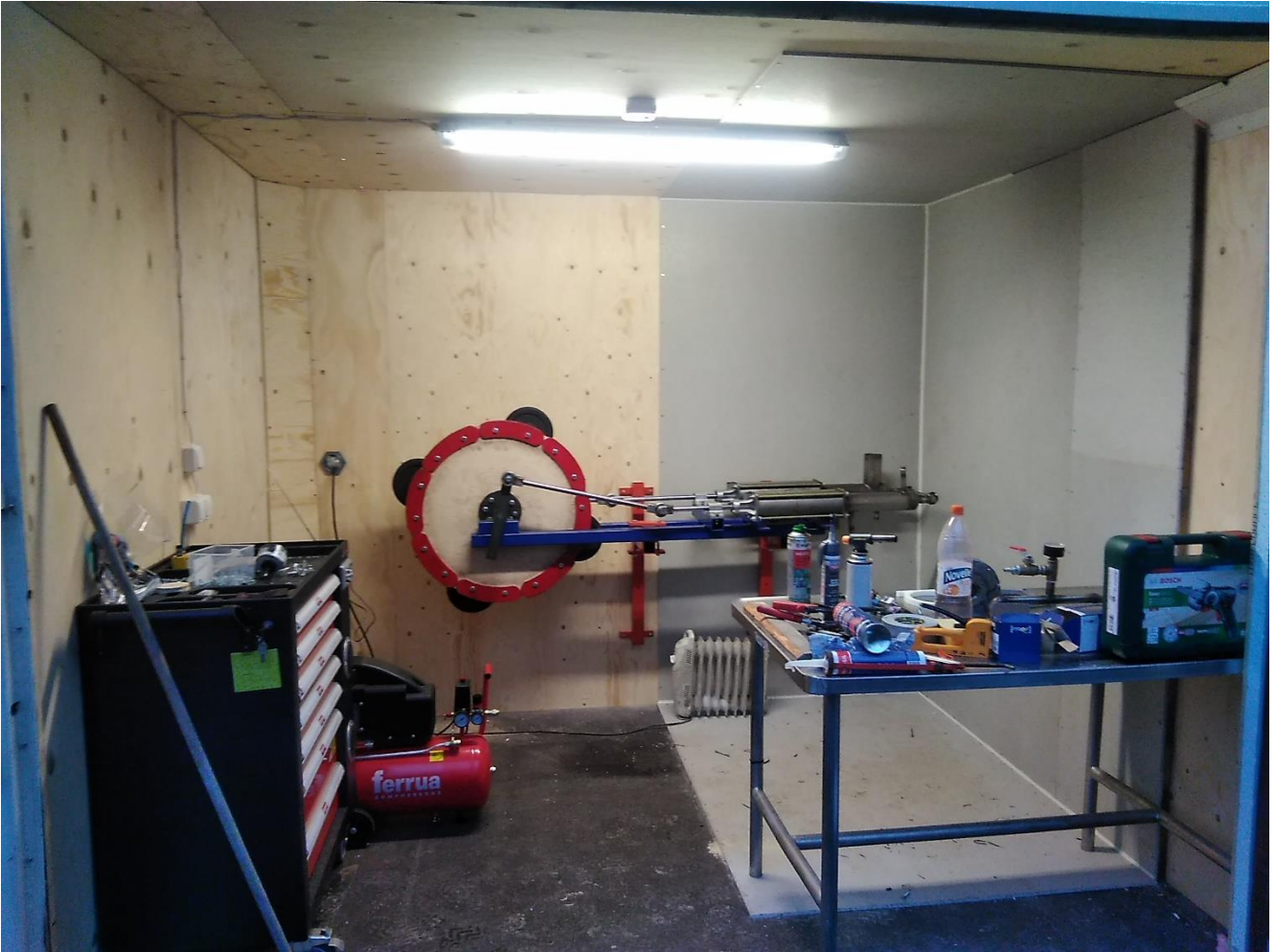
KUVA 11. Valmis pannuhuone, Stirling-moottori seinällä testikäytössä
