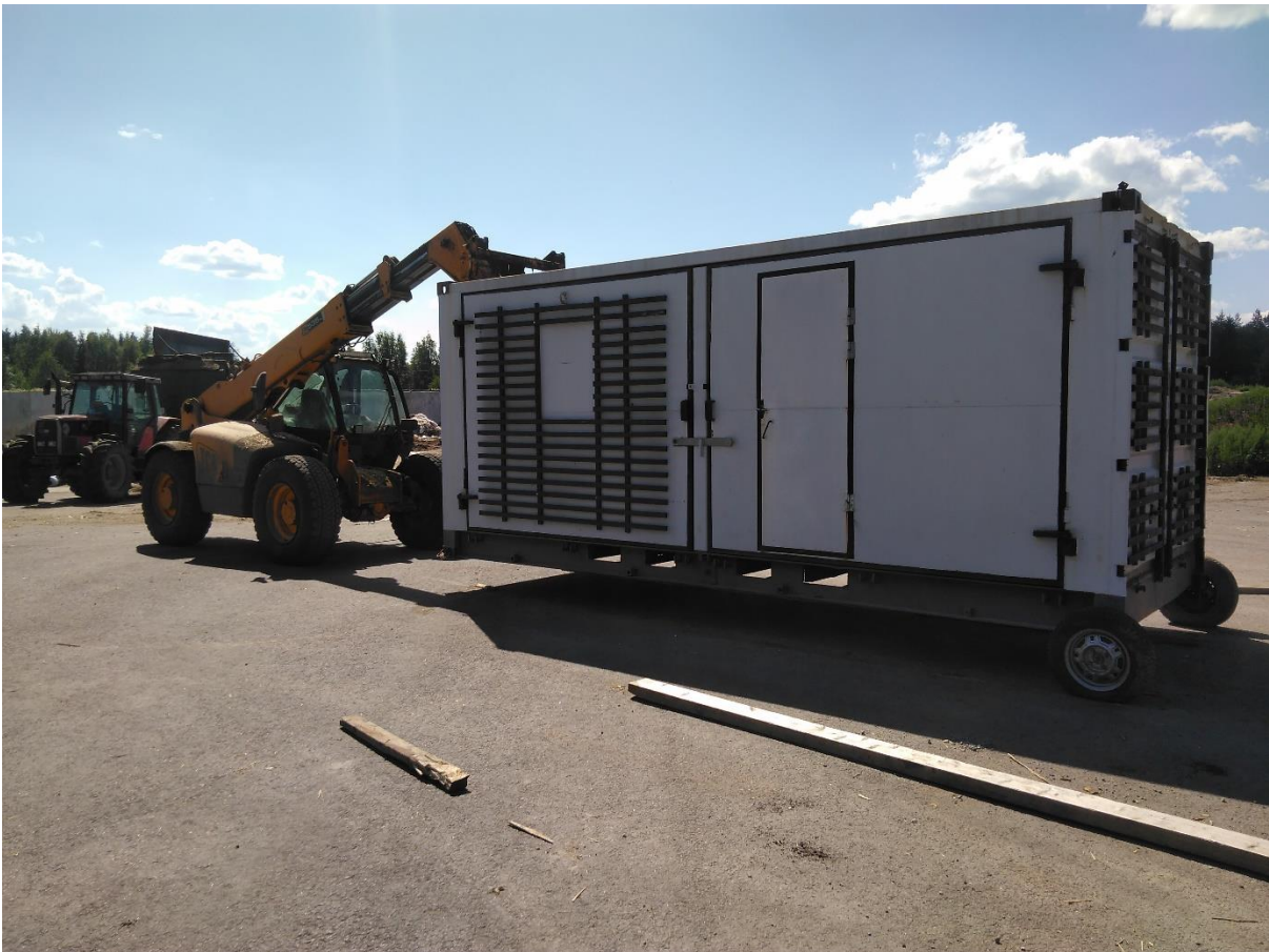
KUVA 6. Merikontin siirto kurottajan ja irrotettavien pyörien avulla
