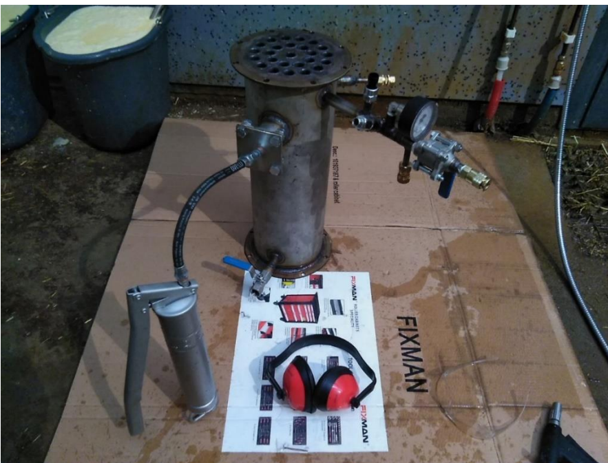
KUVA 54. Hörykattilan koeponnistus vedellä
